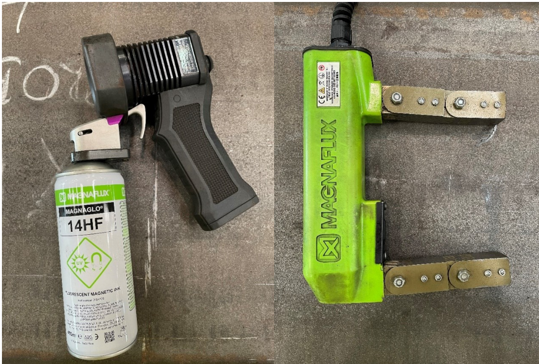
Slika 9.7. Oprema za ispitivanje magnetskim česticama
