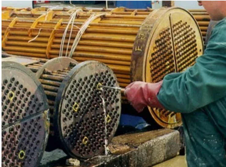
Slika 5.3. Prikaz pristupa ispitivača internim rotirajućim sustavom inspekcije IRIS
