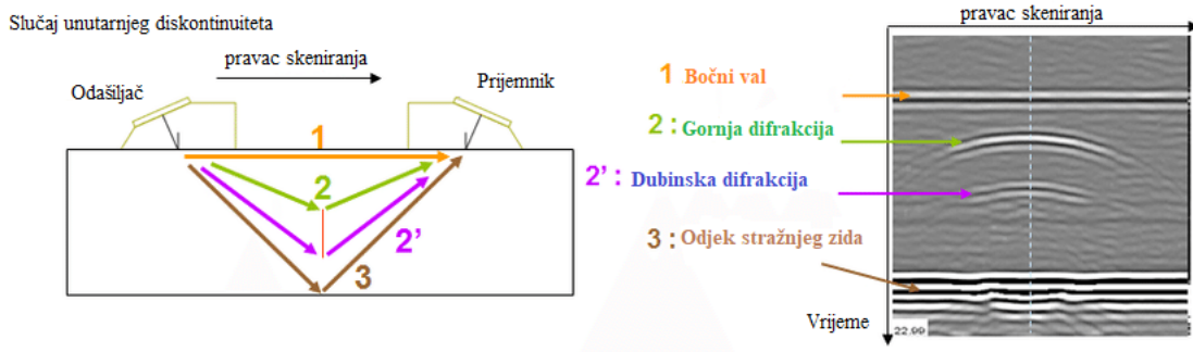
Slika 5.4. Ispitivanje vremena difrakcije leta TOFD pomoću dva ultrazvučna pretvornika
