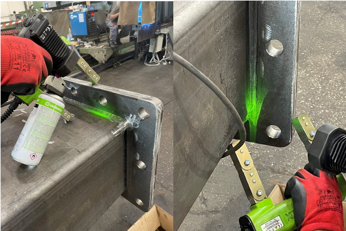
Slika 9.8. Ispitivanje fluorescentnim magnetskim česticama
