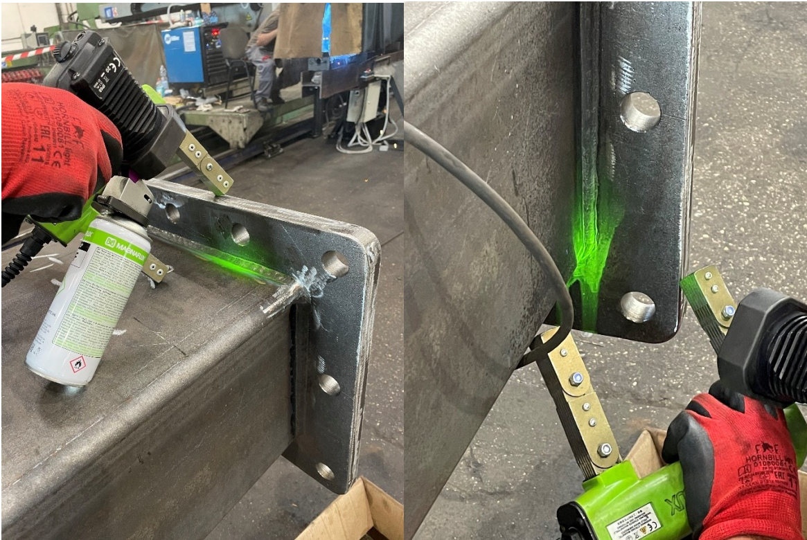
Slika 9.8. Ispitivanje fluorescentnim magnetskim česticama
