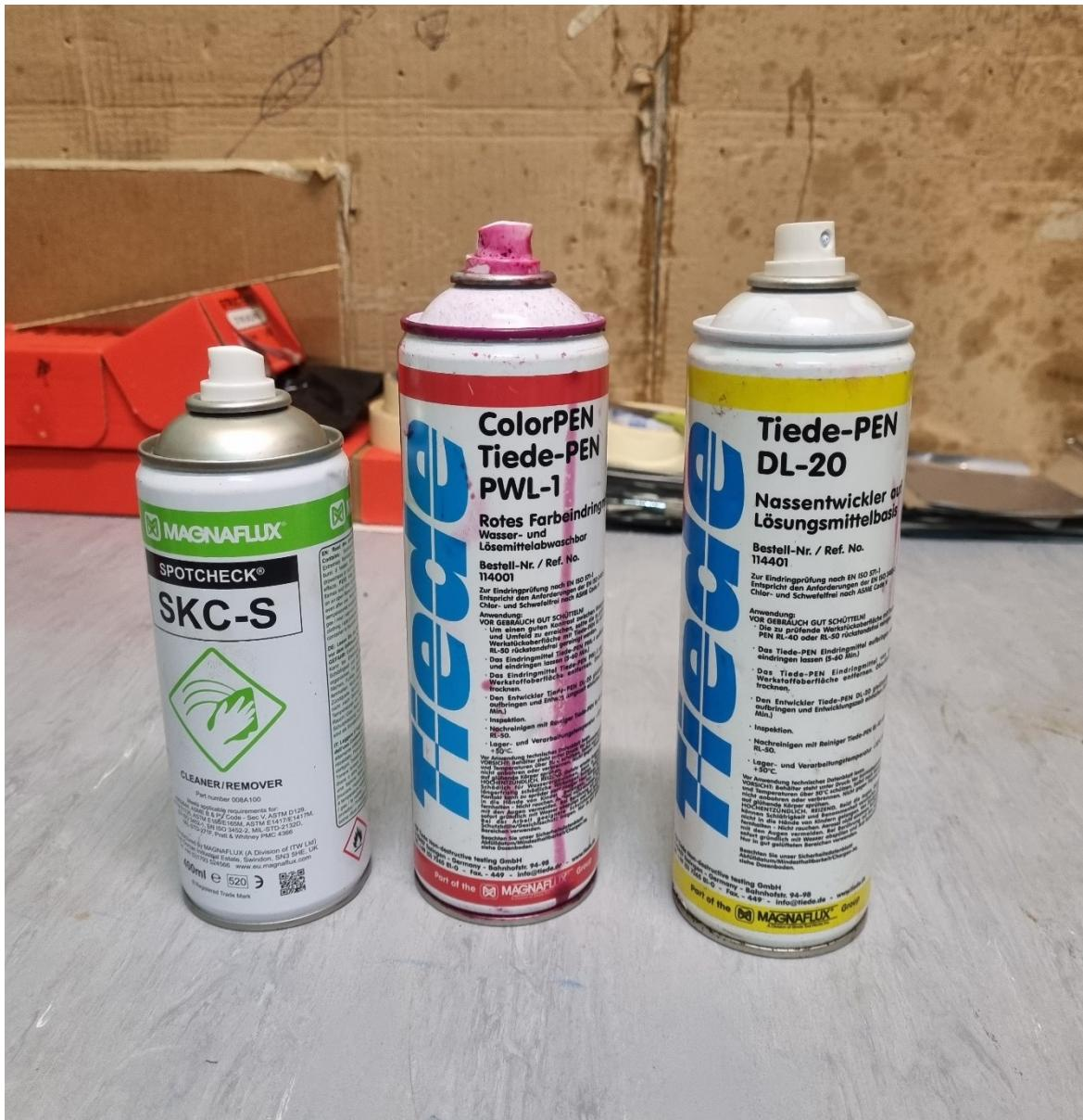
*Slika 5.5. Čistač, penetrant, razvijač*
