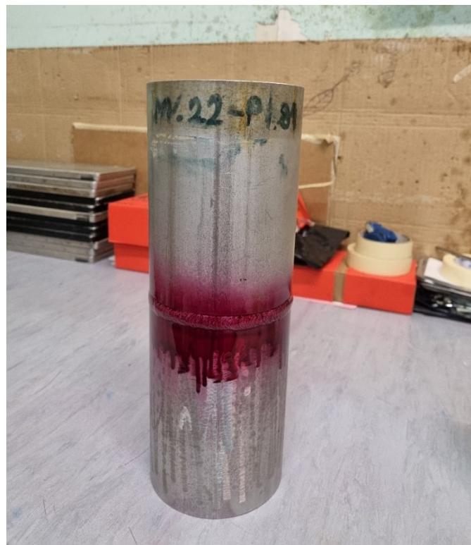
*Slika 5.6. Nanošenje penetranta*
