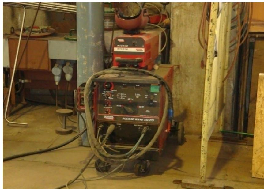
Slika 3.4. Uređaj za TIG zavarivanje
