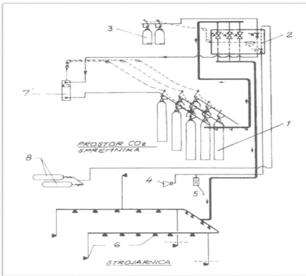
Slika 3.1. Sustav gašenja požara ugljičnim dioksidom u strojarnici
