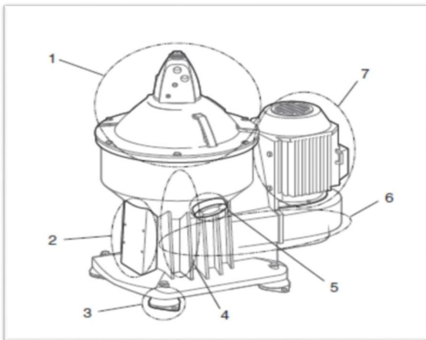
*Slika 3.10. Prikaz centrifugalnog separatora*
