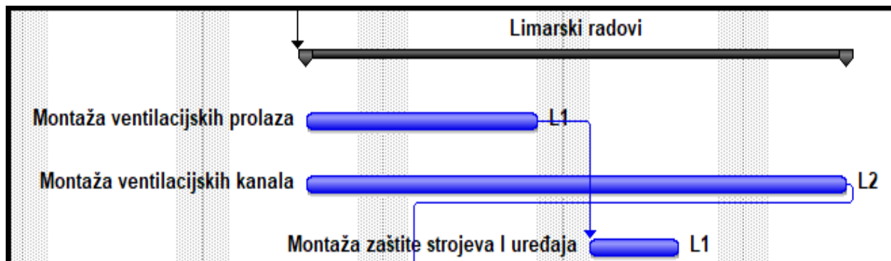
Slika 6. 6. Paralelno izvođenje aktivnosti
