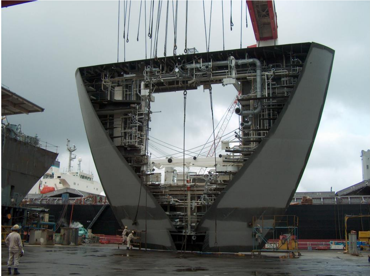
Slika 4.2. Opremanje sekcije strojarnice
