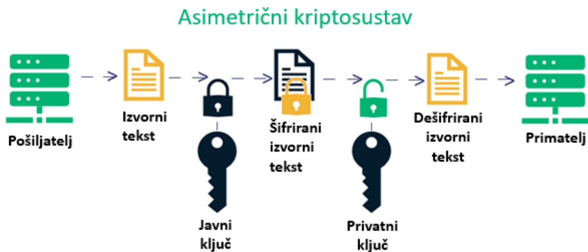
Slika 2.3 Primjer enkripcije javnim ključem [2]
