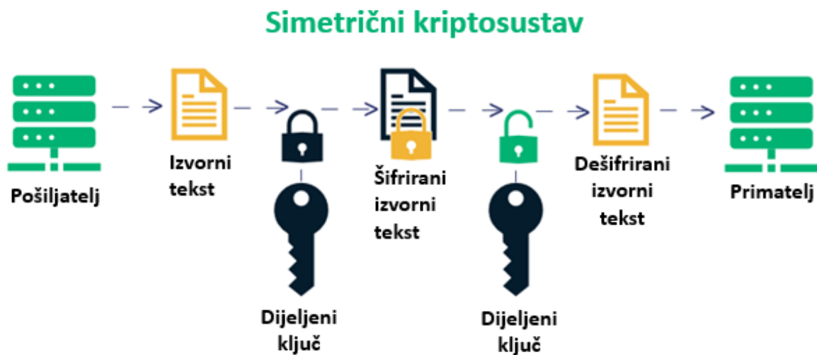
Slika 2.2 Primjer simetrične enkripcije [2]
