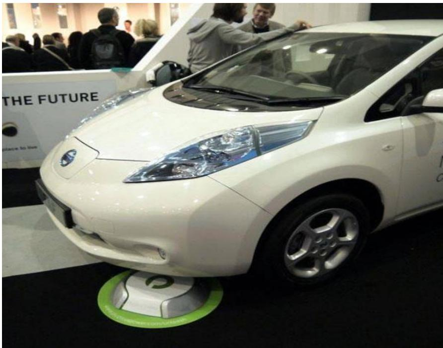
*Slika 3.2. Induktivno punjenje električnog vozila [13]*
