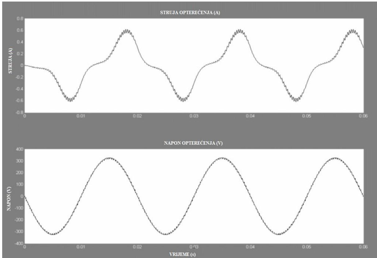
Slika 4.9. Prikaz mrežne struje i napona el. vozila za stanje kvara unutar pretvarača [15]
