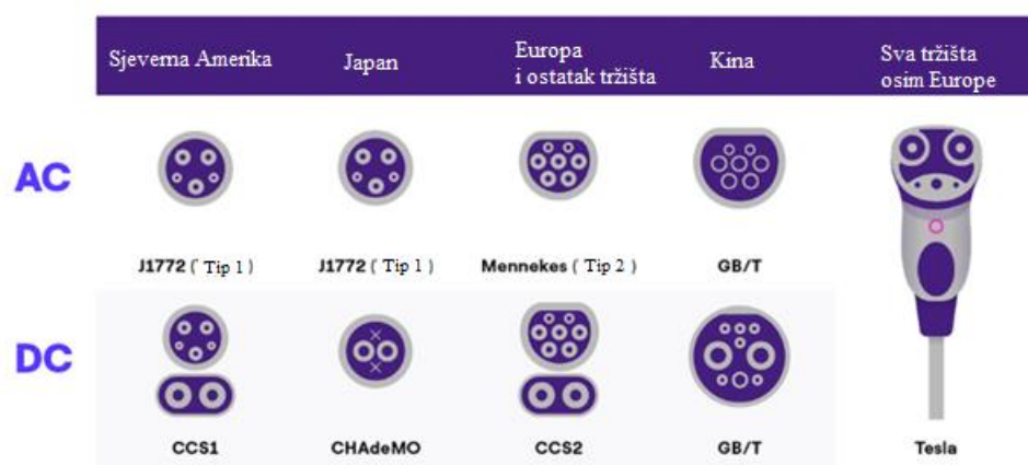
Slika 2.7. Prikaz priključaka s obzirom na regiju i vrstu podržane struje [8]
