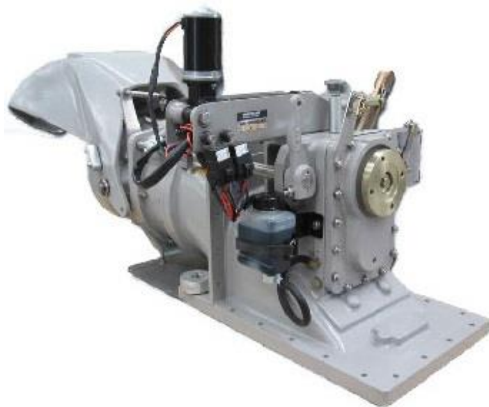
Slika 6.9. Vodolazni propulzor Thrustmaster DJ105 serije 100 [29]
