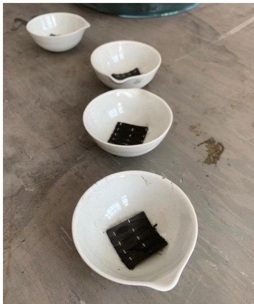
Slika 6.29. Uzorci u posudicama nakon izgaranja smole
