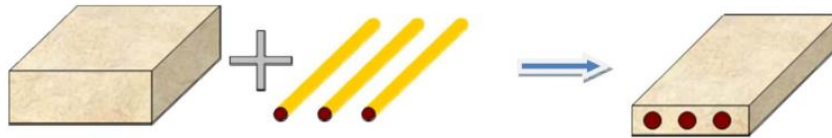
Slika 2.1. Skica kompozitnog materijala [8]
