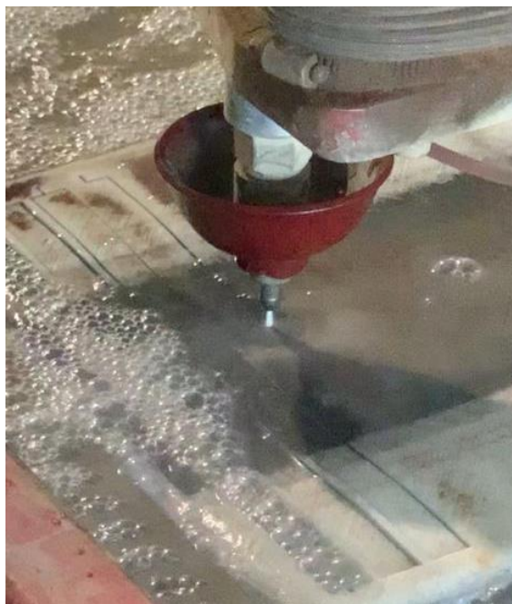
Slika 6.22. Prikaz rezanja vodenim mlazom iz bliza
