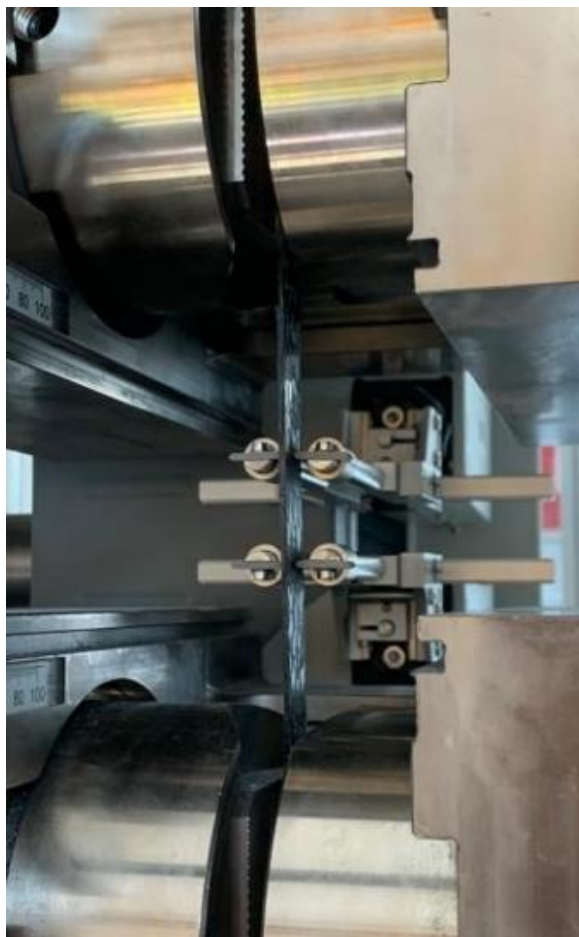
Slika 6.35. Uzorak u čeljustima s prihvatom ekstenzometra u sredini
