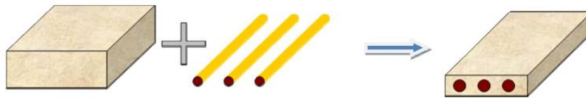
Slika 2.1. Skica kompozitnog materijala [8]
