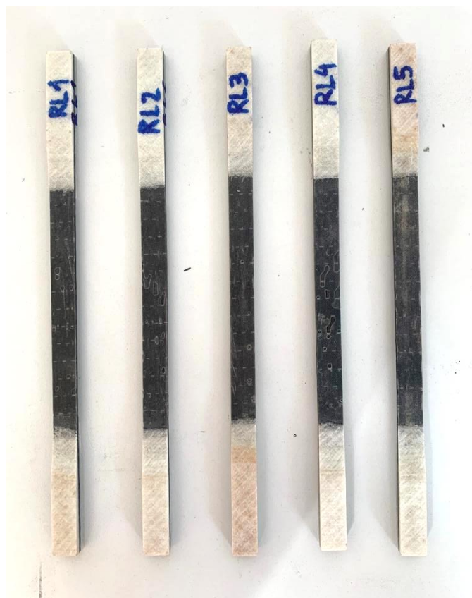
Slika 6.36. Uzorci izrađeni ručnim dodirnim postupkom prije testiranja
