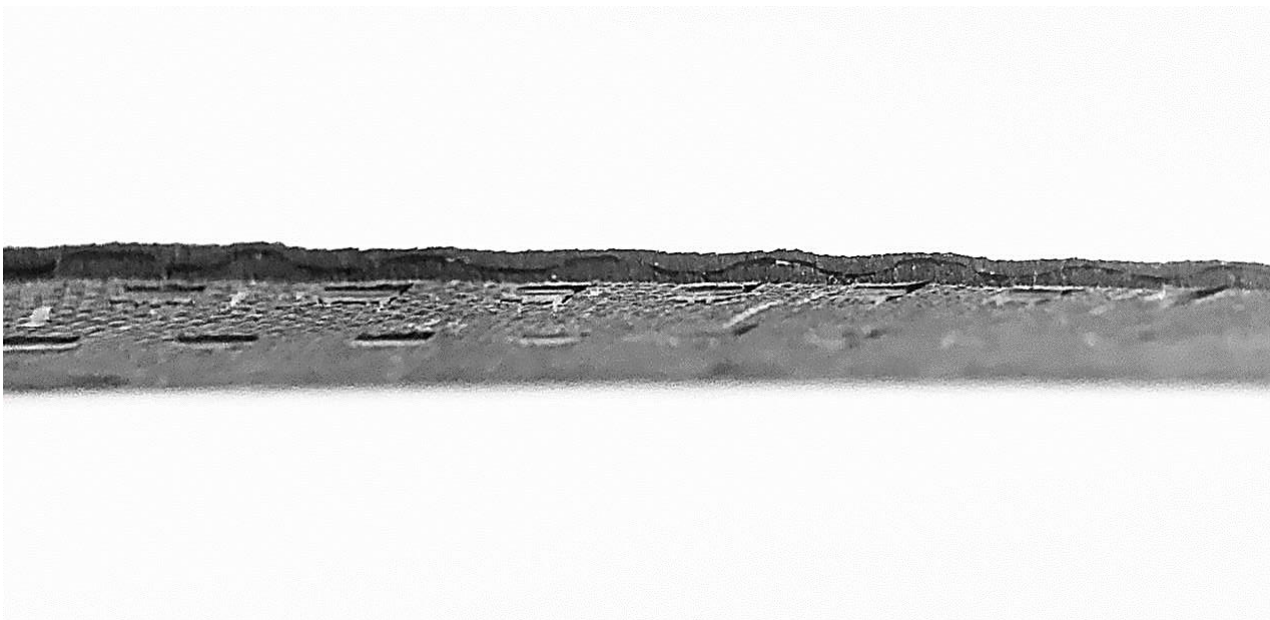
Slika 7.3. Presjek uzorka izrađenog vakuumiranjem mokrog laminata iz bliza
