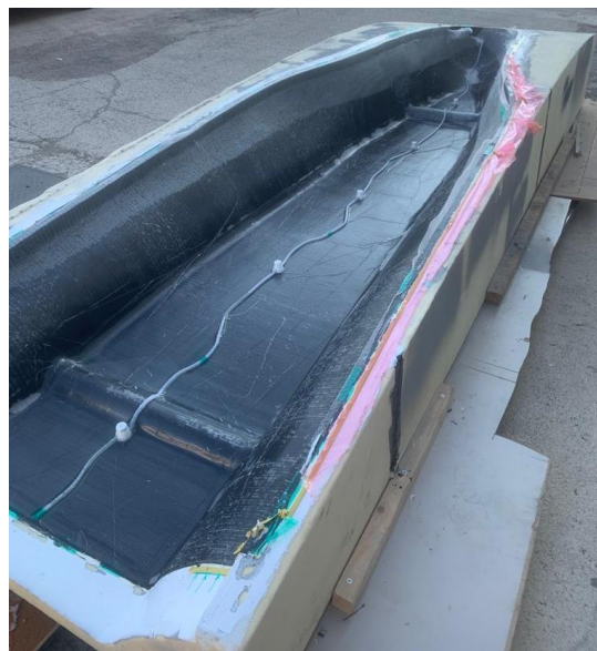
Slika 3.4. Trup sportskog plovila od ugljičnih vlakana napravljen postupkom vakuumske infuzije
