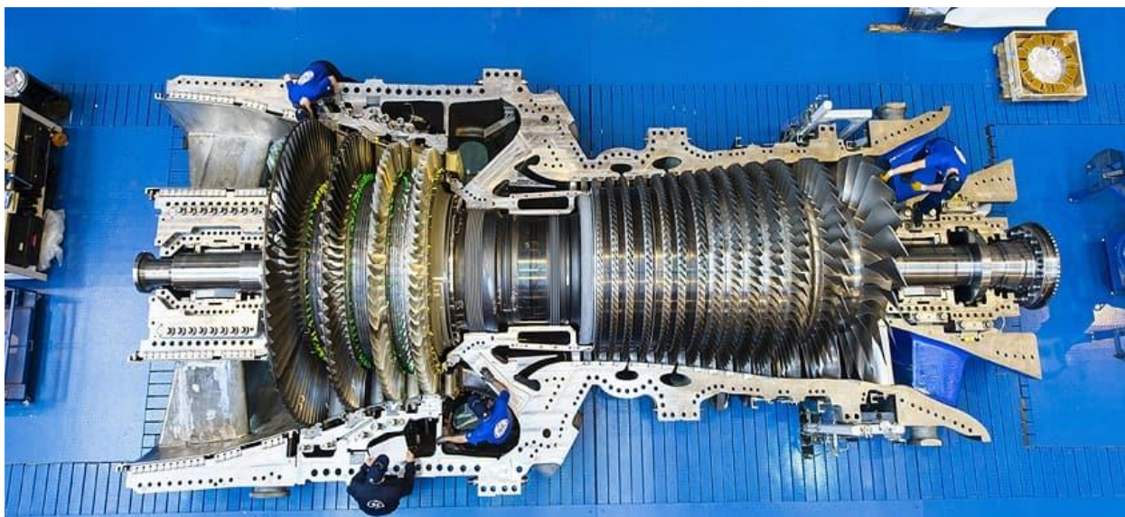
Slika 3.2 Presjek plinske turbine[6]
