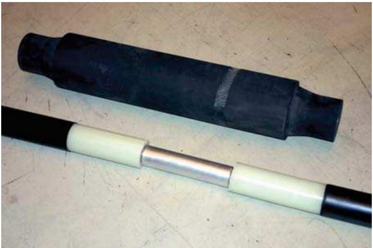
Slika 4.18. Prethodno oblikovana polimerna kabelska spojница. Elastomerni spojni omotač na vrhu. Vodič povezan i izolacija pripremljena za primjenu omotača izolacije na dnu [13]
