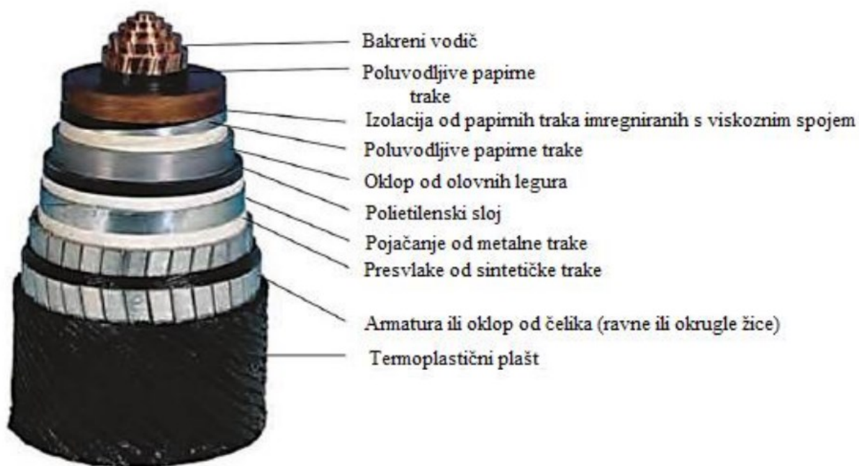
Slika 3.10. MI-PPLP HVDC kabel [12]
