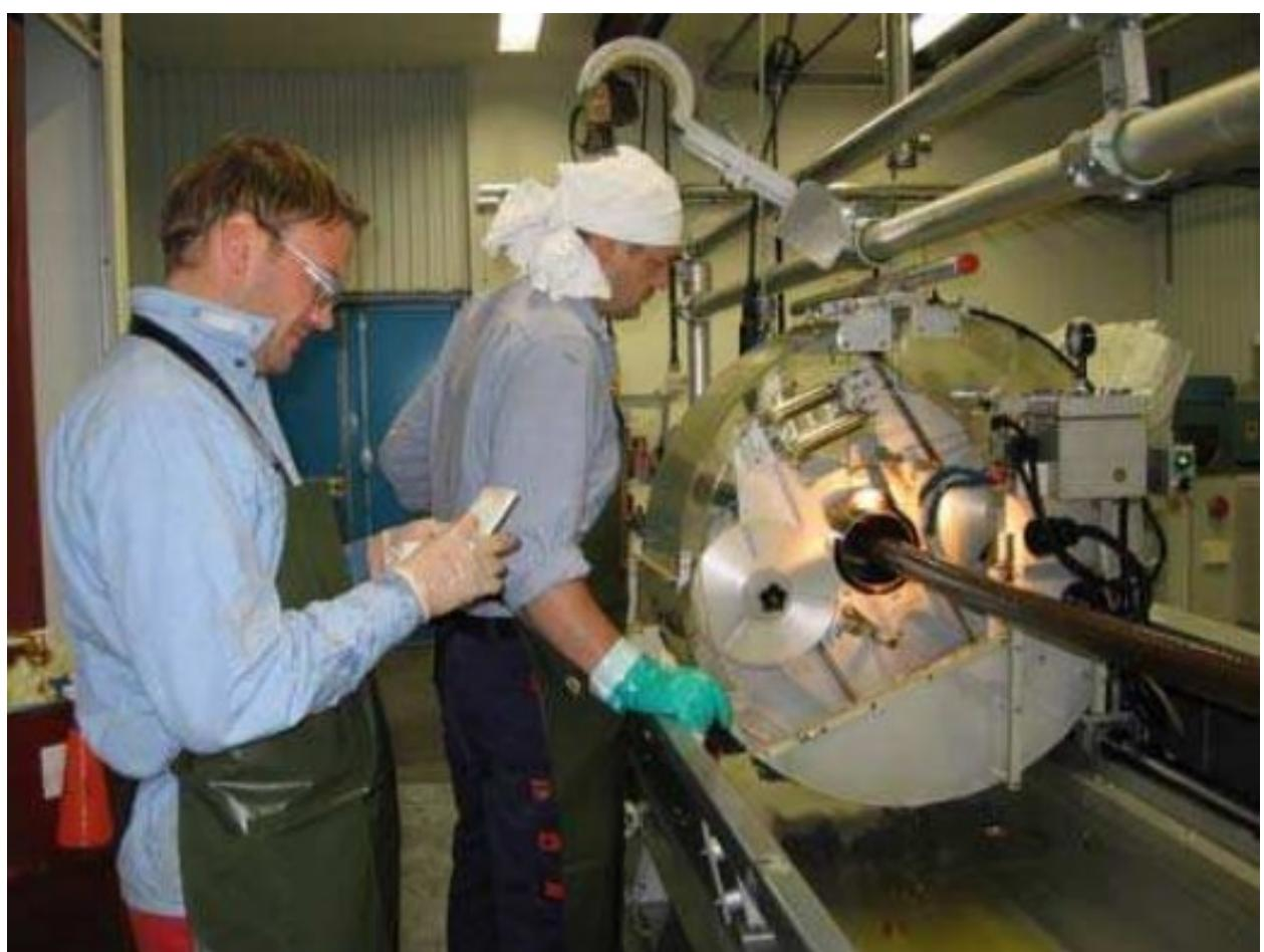
Slika 4.16. *Primjena izolacije od papira za fleksibilni spoj pomoću poluautomatskog stroja za preklapanje (podaci ustupljeni od strane tvrtke ABB, Švedska) [13]*
