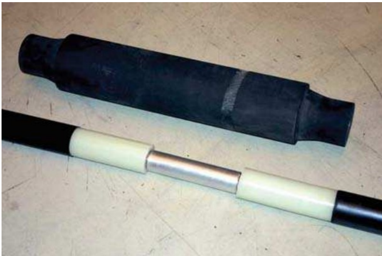
Slika 4.18. Prethodno oblikovana polimerna kabela spojica. Elastomerni spojni omotač na vrhu. Vodič povezan i izolacija pripremljena za primjenu omotača izolacije na dnu [13]
