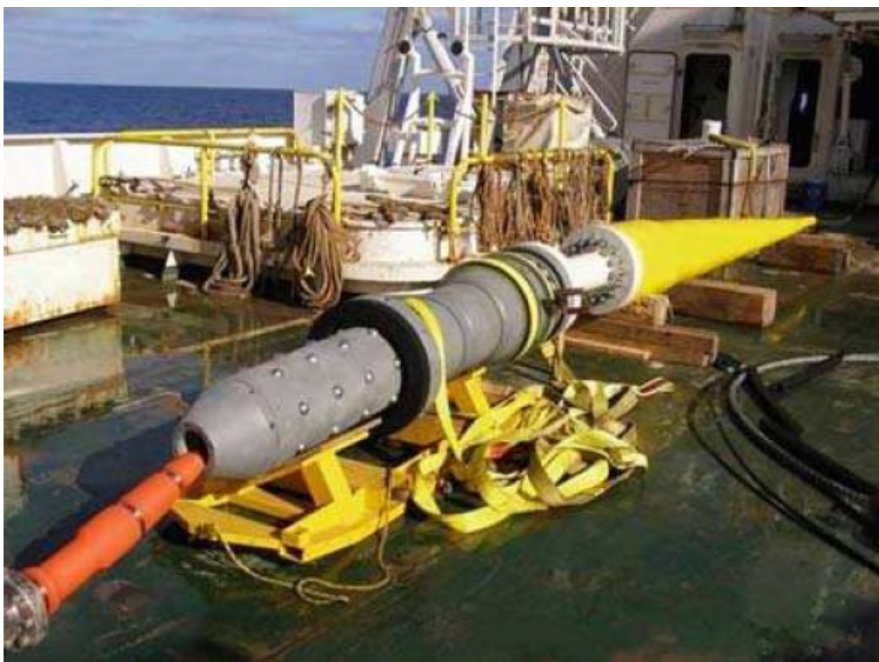
Slika 4.24. Ograničavač savijanja (desna ruka) zajedno sa podmorskim priključkom bez potrebe za ronjenjem (lijeva strana) (podaci ustupljeni od strane Trelleborg, Velika britanija) [13]
