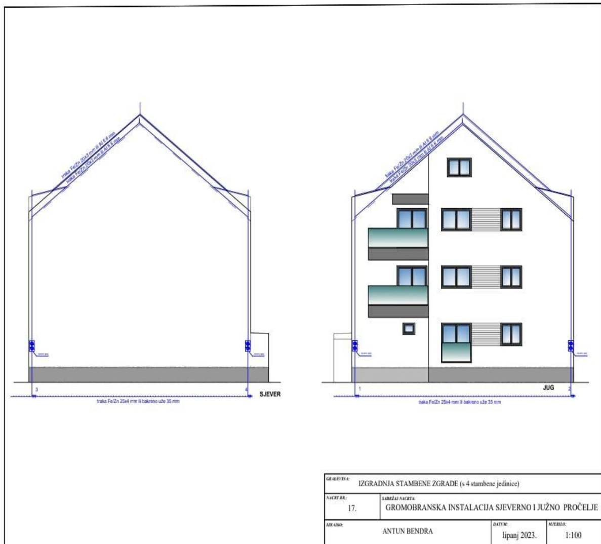
Slika 7.2 Prikaz gromobranske instalacije pročelja
