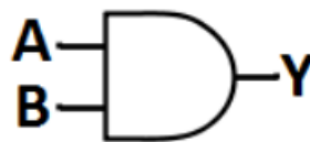
Slika 2.1 Logička vrata I - simbol (Izvor:[4]).
