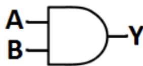
Slika 2.1 Logička vrata I - simbol (Izvor:[4]).
