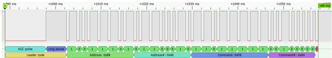
Slika 3.2 Slanje jednog bajta NEC protokola.
