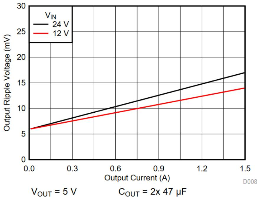
Slika 6.5 Izlazna valovitost napona TPSM84 silaznog pretvarača.
