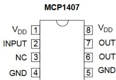
Slika 6.7 MCP1407 PDIP kućište s oznakama pinova.
