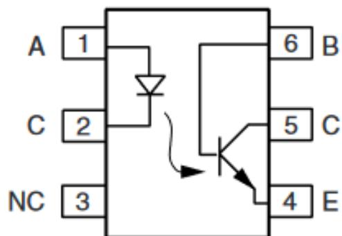
Slika 6.9 4N35 PDIP kućište s oznakama pinova.
