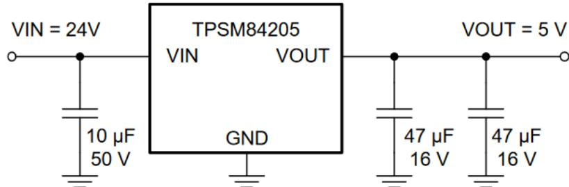
Slika 6.4 Tipičan spoj TPSM84 silaznog pretvarača.
