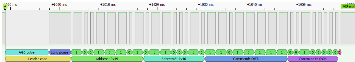
Slika 3.2 Slanje jednog bajta NEC protokola.
