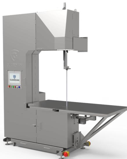
*Slika 25.4 Prikaz tračne pile*
