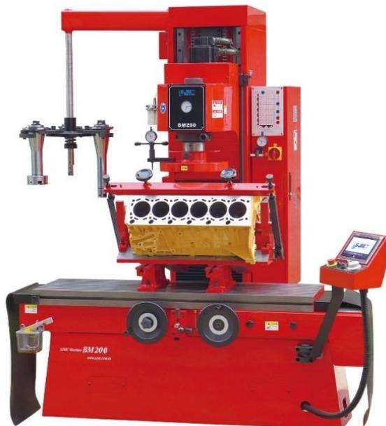
*Slika 25.3 Prikaz stroja sa bušenje cilindra*
