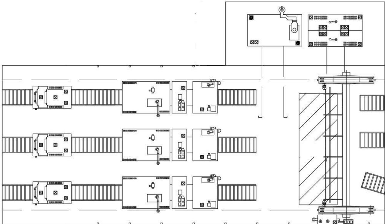
Slika 14 Prikaz radionice predobrade limova i profila
