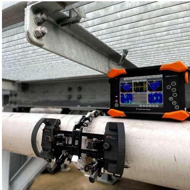
*Slika 17.7 Prikaz uređaja za inspekciju zavara*
