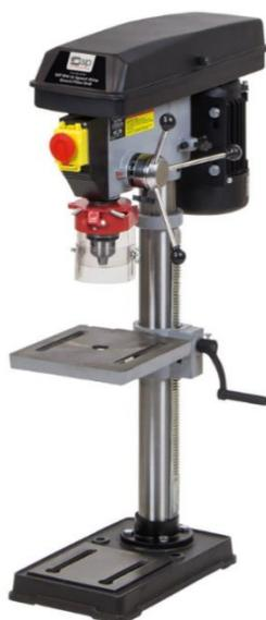
*Slika 24.4 Prikaz stupne bušilice*
