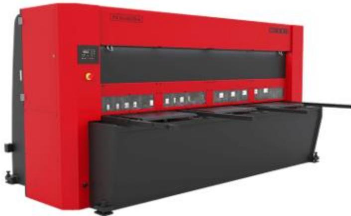
Slika 21.2 Prikaz hidrauličkih škara
