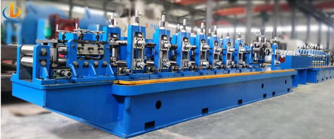
Slika 22.1 Prikaz linije za izradu cijevi
