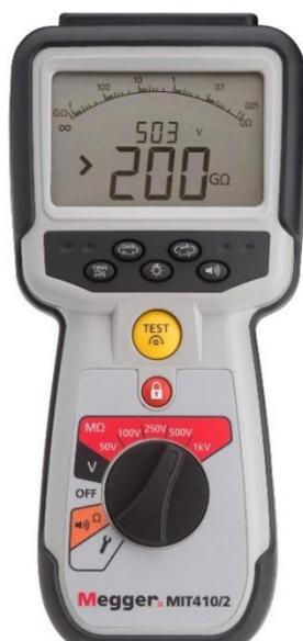
Slika 24.1 Prikaz ispitivača izolacije
