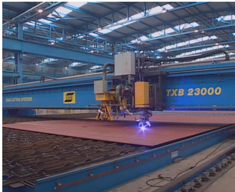
Slika 4.3.1.1. Paralelno plinsko rezanje brodskih limova
