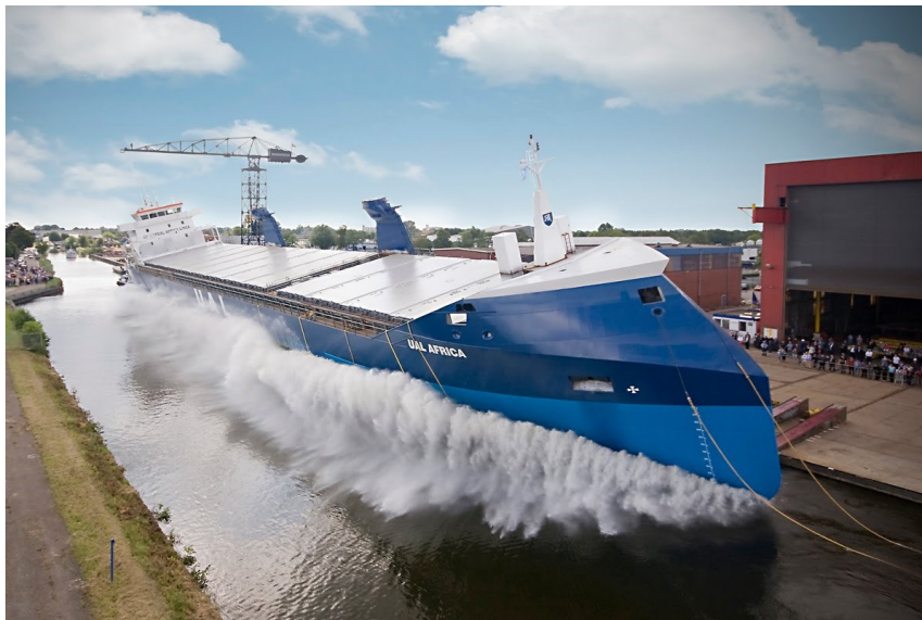
Slika 6.2. Poprečno porinuće na kosom navozu
