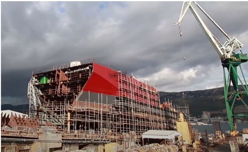
Slika 6.1.1. Montaža broskog trupa na navozu (Brodosplit)
