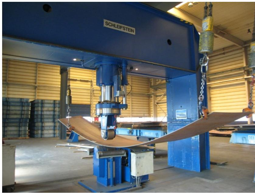
Slika 4.3.2.1. H-preša za savijanje limova
