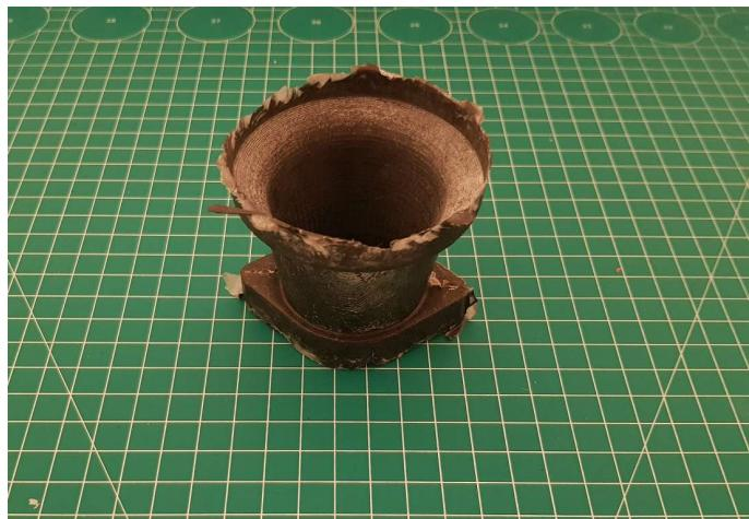
Slika 5.7. Izradak neposredno nakon vađenja iz alata
