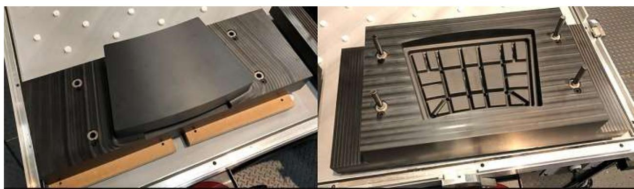
*Slika 3.2. Alat izrađen od kompozitnih materijala aditivnom tehnologijom*
