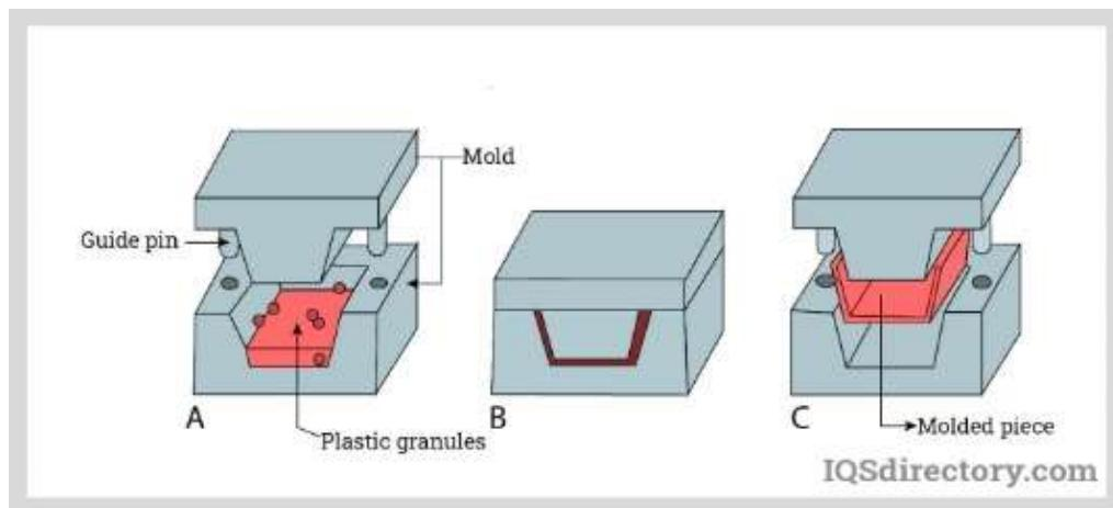
Slika 4.6. Shematski prikaz kompresijskog alata
