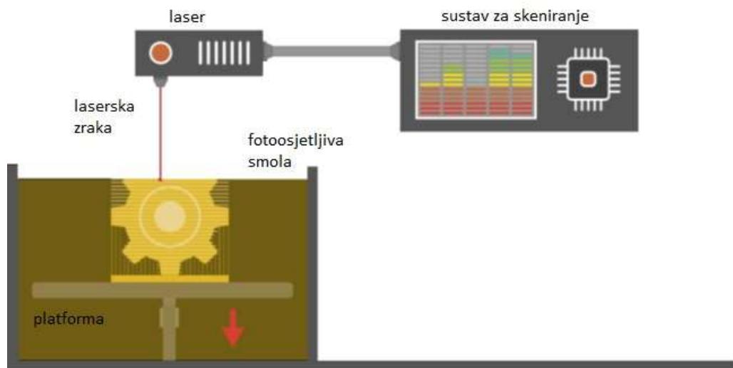
*Slika 2.4. Izrada stereolitografijom*
