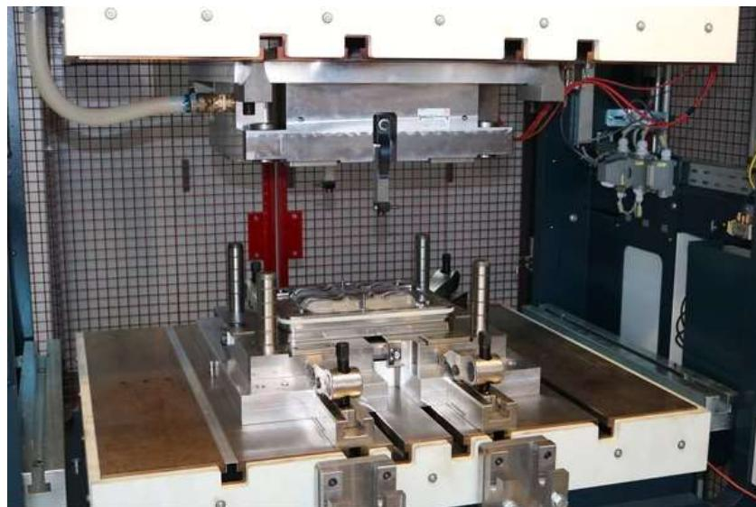
*Slika 3.1. Hidraulična preša sa grijanim alatom*
