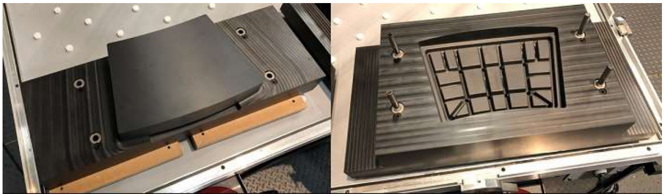
Slika 3.2. Alat izrađen od kompozitnih materijala aditivnom tehnologijom
