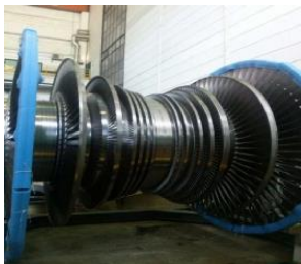
Slika 14. Niskotlačni dio parne turbine [5]
