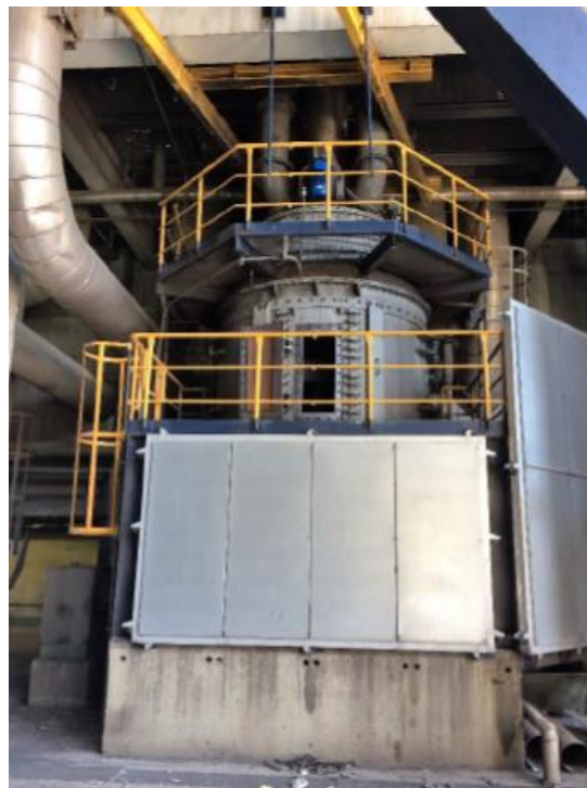
Slika 12. Mlin za usitnjavanje ugljena [5]
