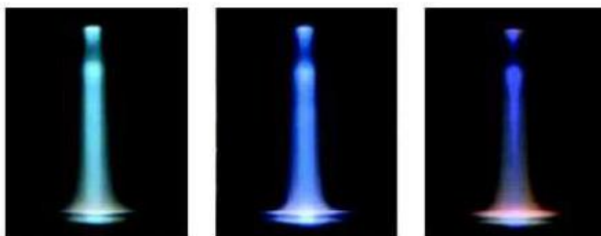
Slika 2.5. Toplinska plazma generirana različitim plinovima pri 100A (dušik, zrak, kisik)
