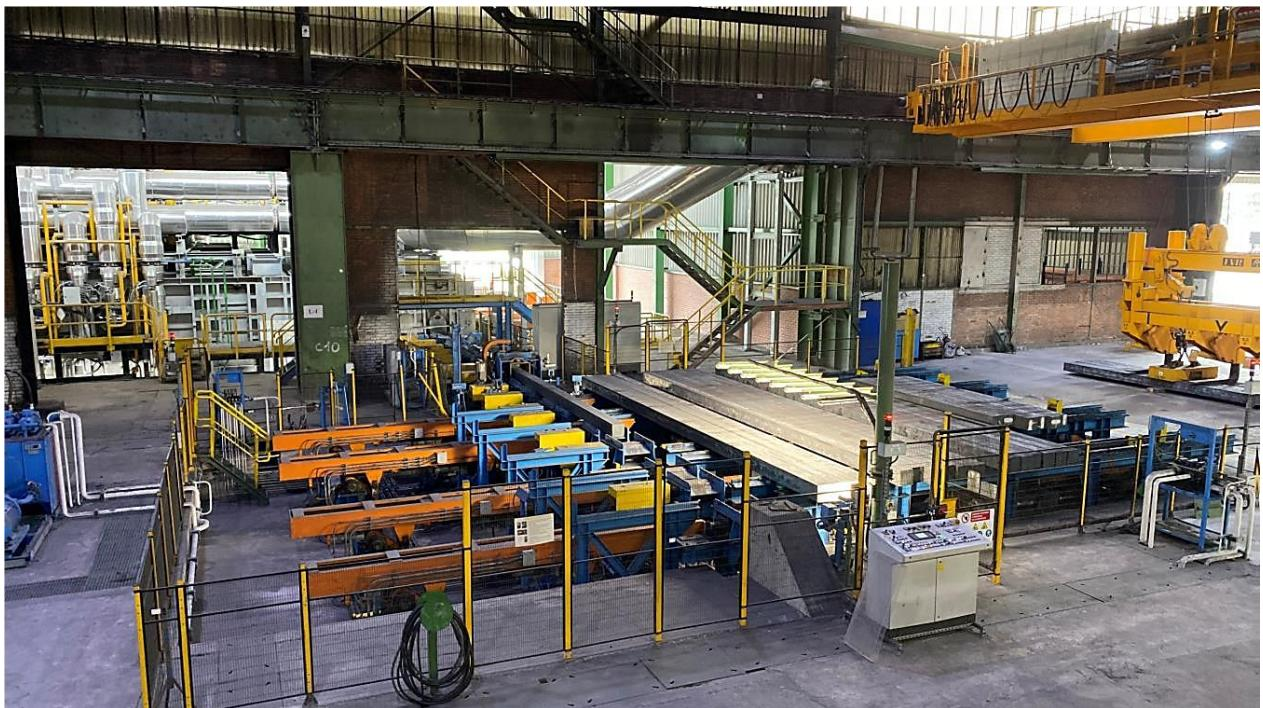
Slika 3.1. Slika rešetke za punjenje peći [autor]
