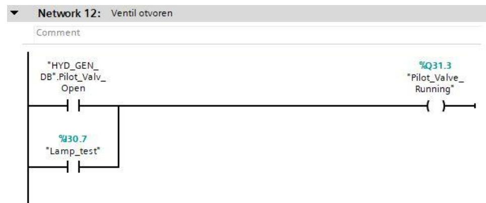
Slika 6.15. Stanje pilotnog ventila
