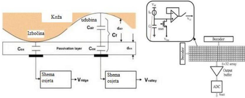
Slika 3.4. Princip rada kapacitivnog senzora [43]
