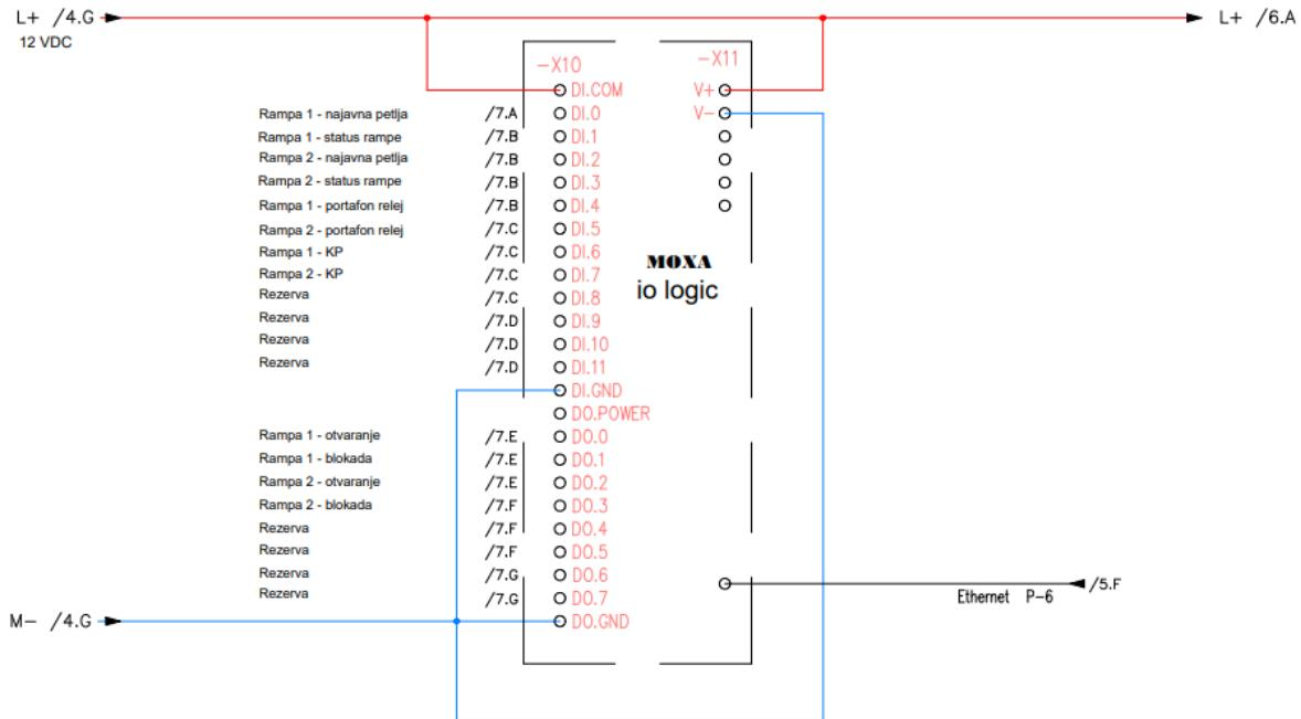
Slika 4.23. Shema spajanja ulazno/izlaznog uređaja [Izrada autora]
