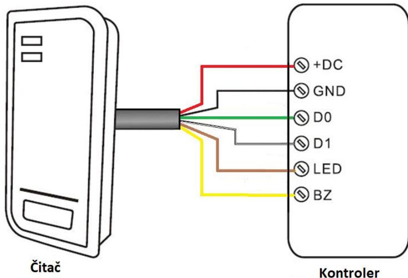
*Slika 2.18. Način spajanja Wiegand standarda [24]*
