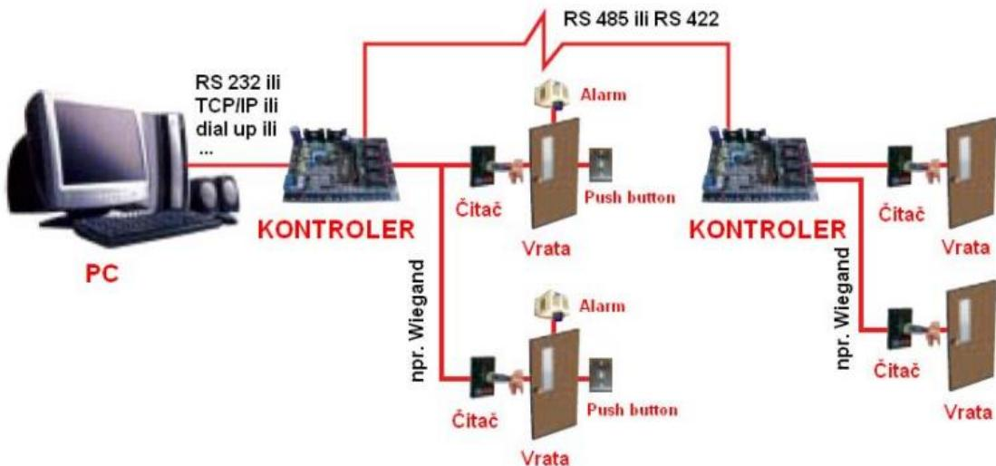
Slika 2.1. Primjer sustava kontrole pristupa za četiri vrata [3]
