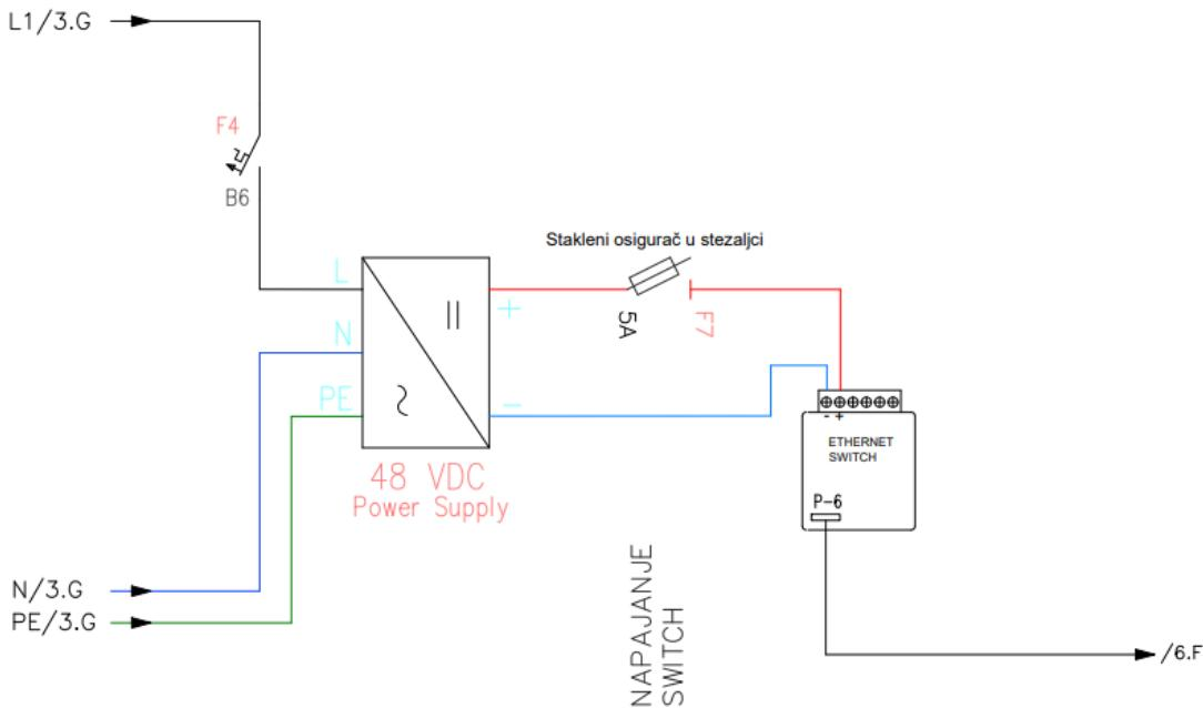
Slika 4.22. Shema spajanja napajanja 48 VDC [Izrada autora]
