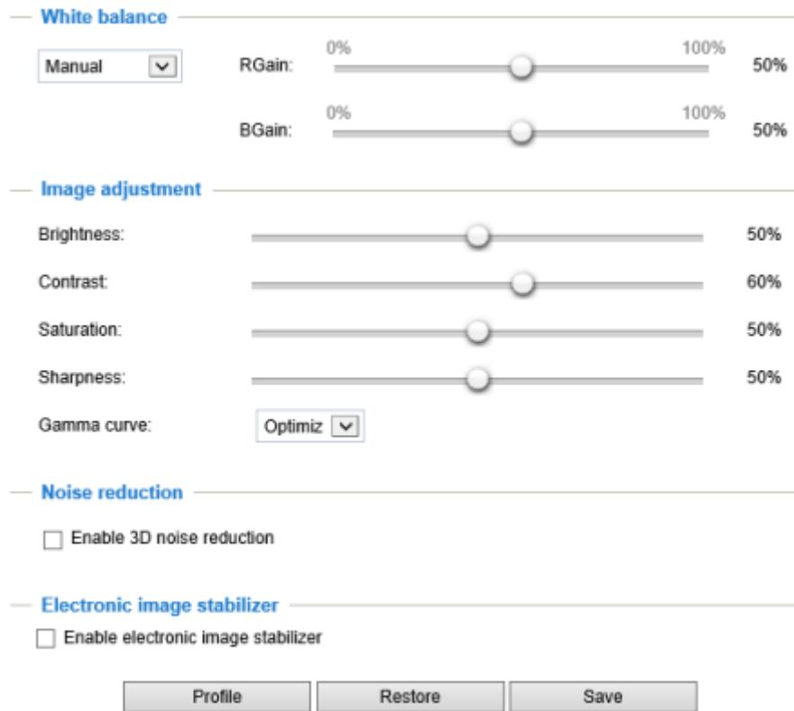
Slika 4.30. Postavke svjetline, kontrasta, zasićenosti i oštrine [Izrada Autora]
