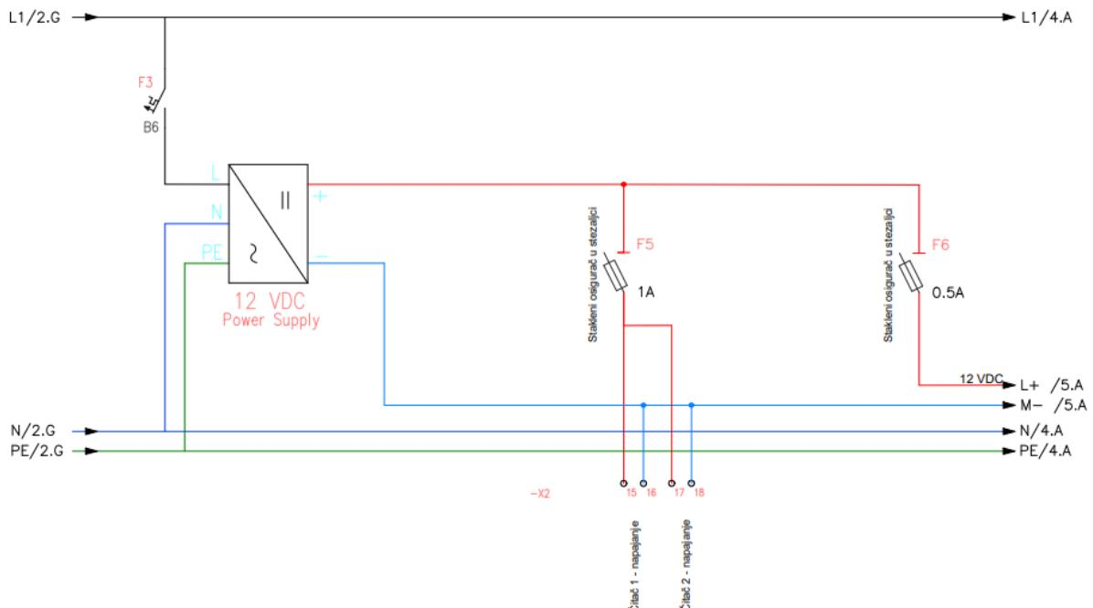
Slika 4.21. Shema spajanja napajanja 12 VDC [Izrada autora]
