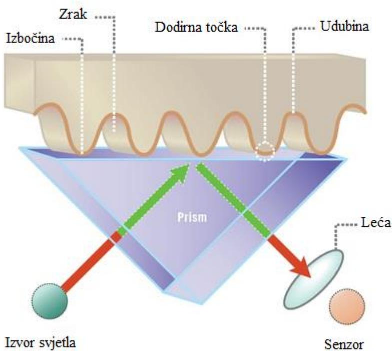
*Slika 3.3. Princip rada optičkog senzora [42]*
