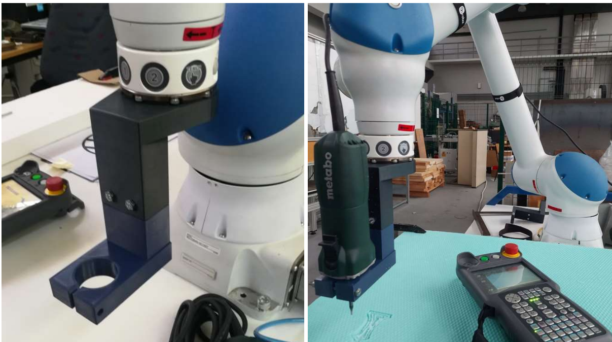
Slika 4.10. Montiranje prihvatnice i Metabo motor-vretena.
