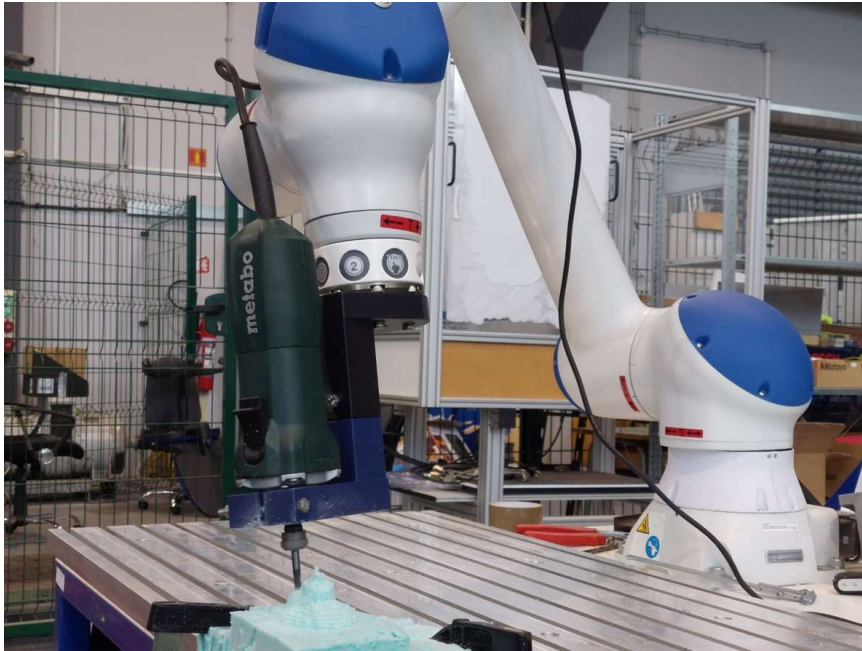
Slika 4.64. Stezanje sirovca i proces grube obrade.
