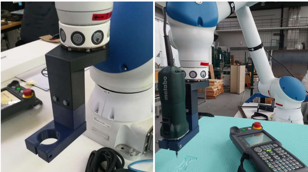
Slika 4.10. Montiranje prihvatnice i Metabo motor-vretena.
