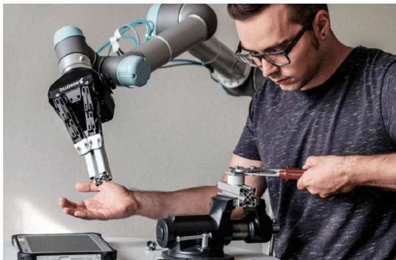
Slika 3.1. Korištenje kobota kao asistenta pri montaži [27].
