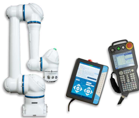
Slika 3.3. Robotska ruka Yaskawa MOTOMAN HC10DT.
