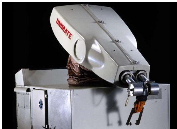
Slika 2.1. Prvi industrijski robot - Unimate [6].
