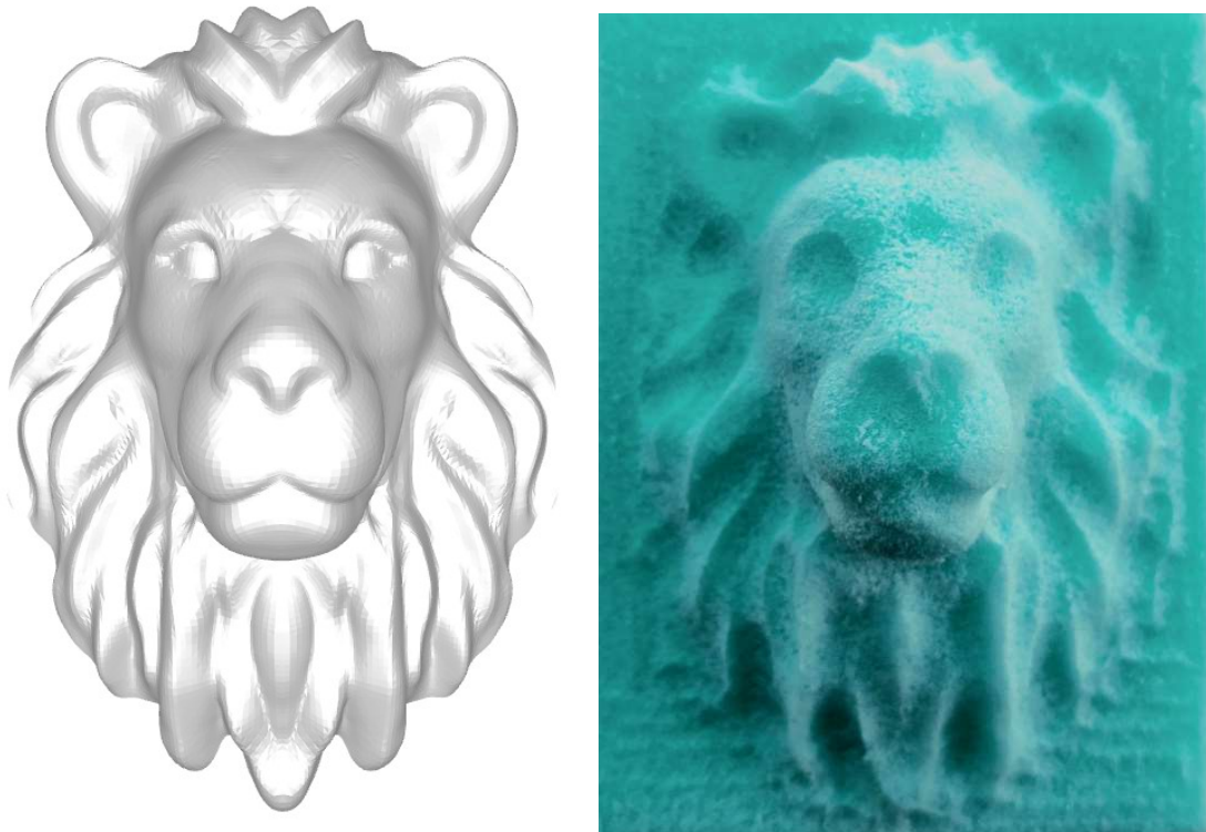
Slika 4.66. Prikaz fino glodanog modela lava u usporedbi s 3D modelom.
