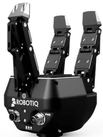
Slika 3.14. Mehanička hvataljka s tri pokretna prsta tvrtke Robotiq [34].
