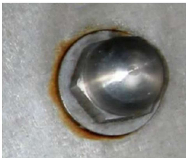
Slika 4.4: Korozija u procijepu [11]
