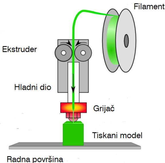
Slika 3.1 Shematski prikaz principa rada FDM aditivne proizvodnje [19]
