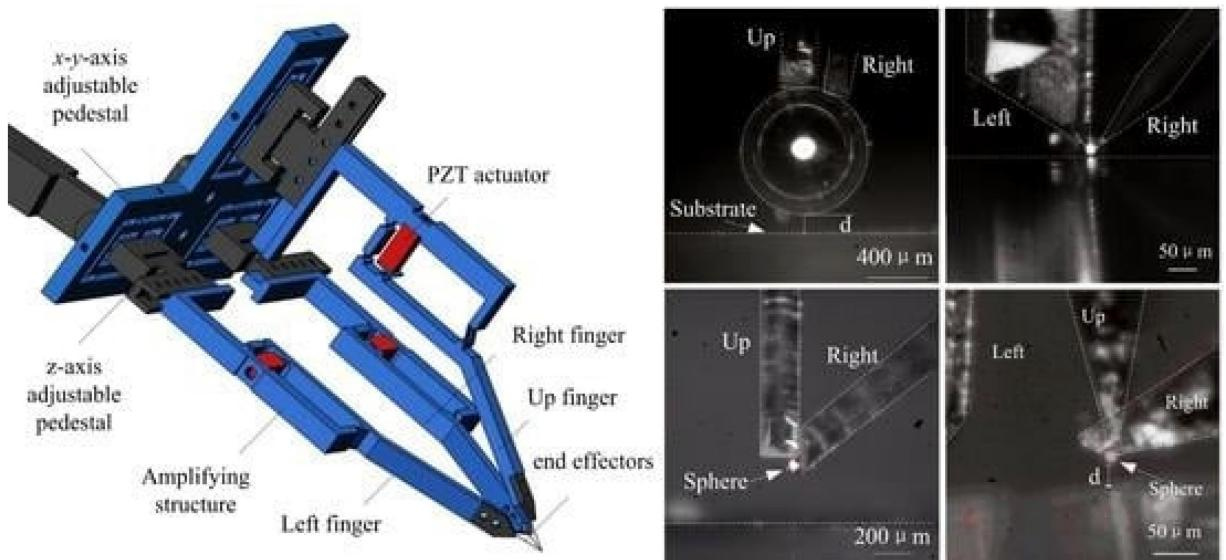
Slika 2.19 Mikrohvataljka za pozicioniranje žice [13]
