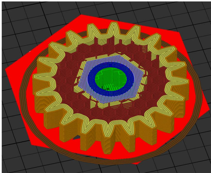
Slika 3.8 Presjek jednog sloja 3D tiskanog zupčanika
