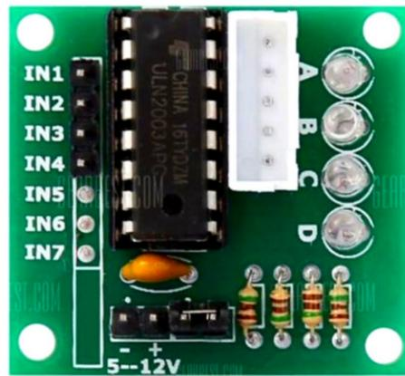
Slika 5.4 Upravljačka jedinica ULN2003
