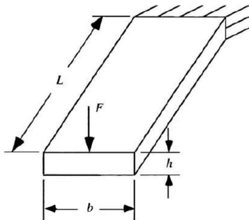
Slika 4.1 Opterećenje silom na podatljivi element [2]
