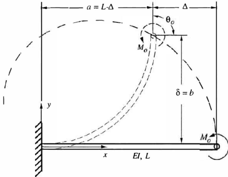
Slika 4.3 Precizni Bernoulli- Eulerov model zakrivljenosti [2]
