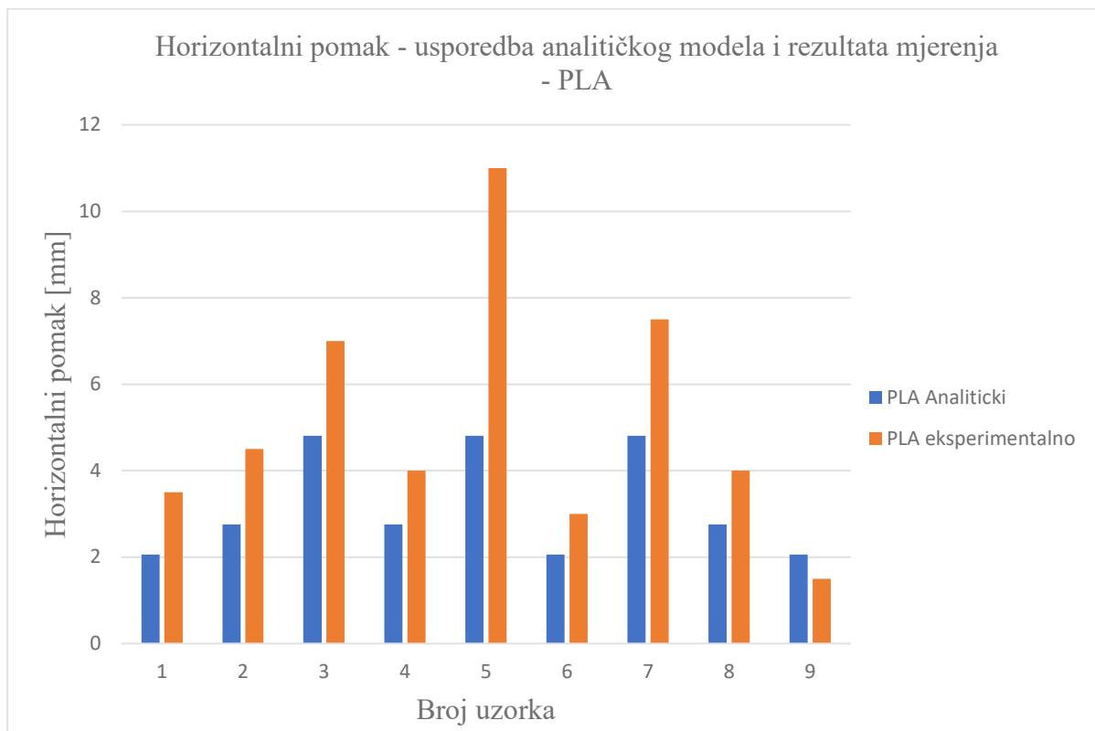
Slika 6.4 Horizontalni pomak - usporedba analitičkog modela i rezultata mjerena – PLA
