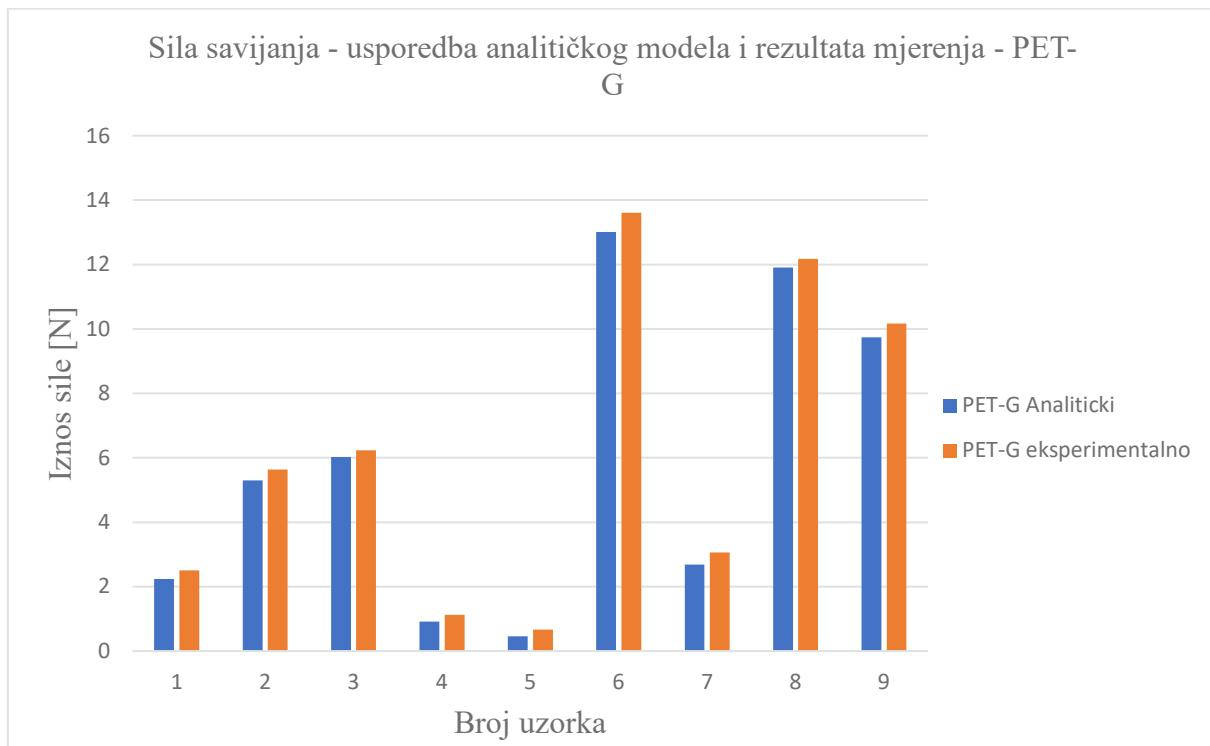
Slika 6.7 Sila savijanja - usporedba analitičkog modela i rezultata mjerjenja - PET-G
