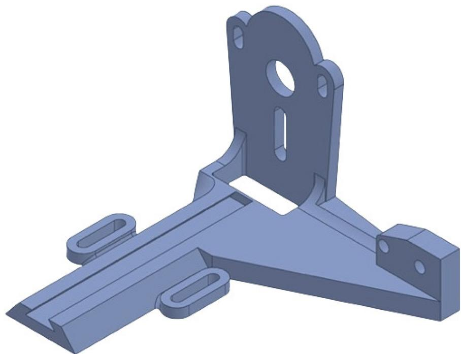
Slika 5.16 CAD model nosača motora
