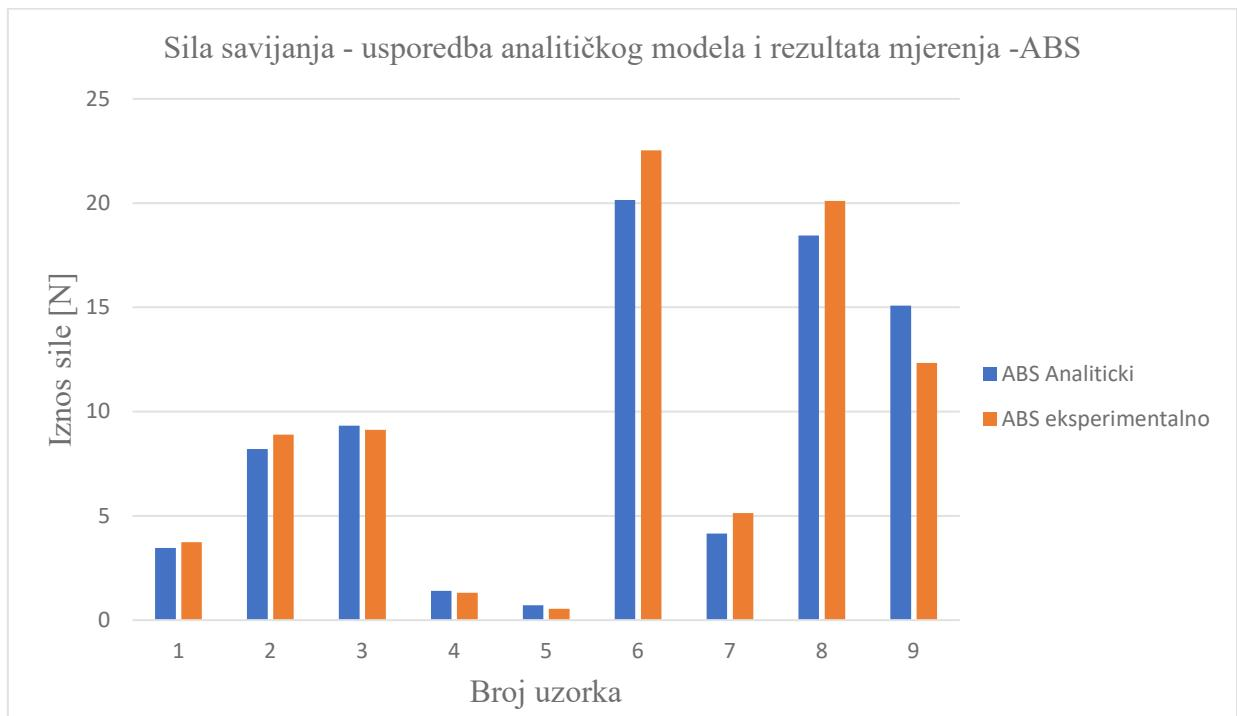
Slika 6.5 Sila savijanja - usporedba analitičkog modela i rezultata mjerena -ABS
