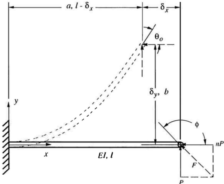
Slika 4.4 Bernouli- Eulerov model elastičnosti sa složenim opterećenjem [2]
