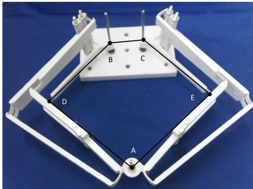
Slika 2.13 Dijelomično podatljivo mehanizam-pantograf [9]
