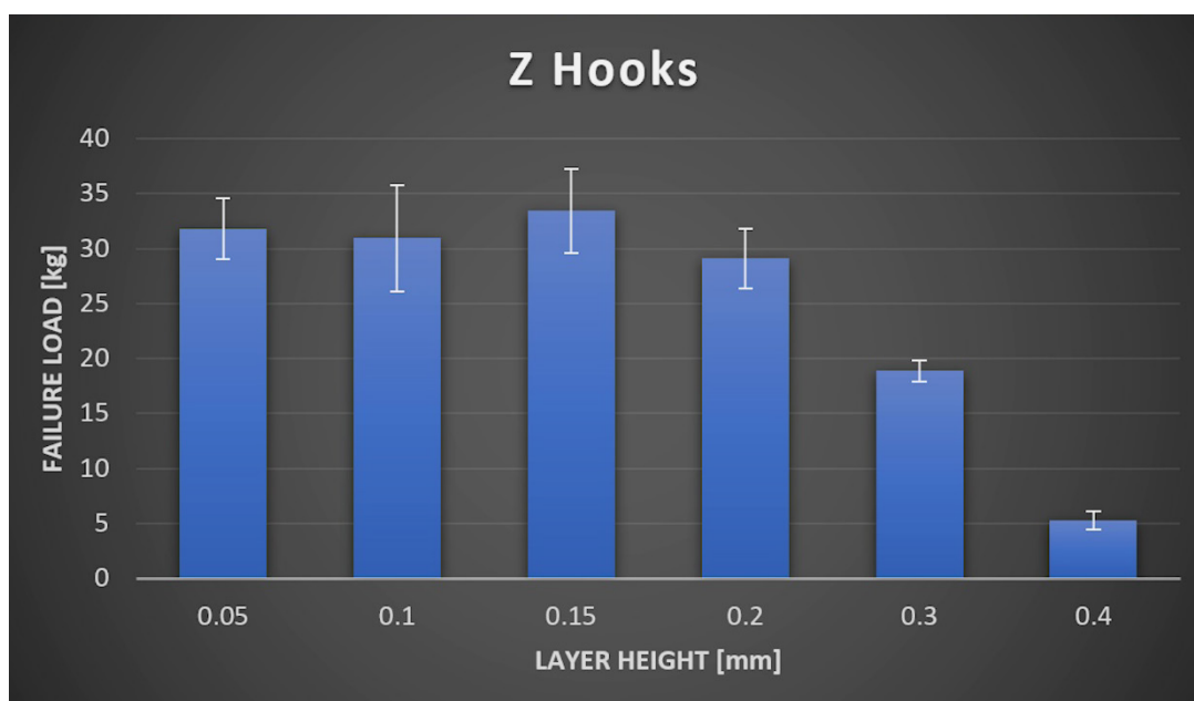
Slika 3.6 Utjecaj visine sloja na vlačnu čvrstoću [20]
