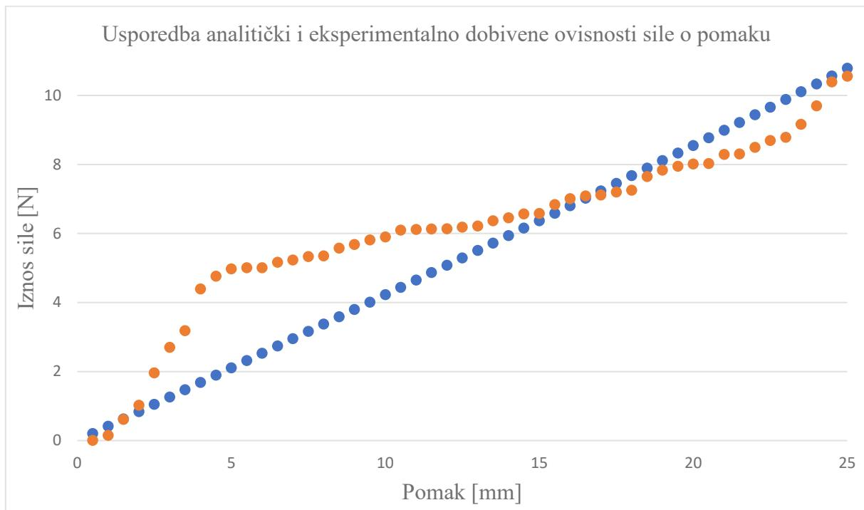
Slika 6.2 Usporedba analitički i eksperimentalno dobivene ovisnosti pomaka slobodnog kraja lisnate opruge tipa PLA 3 o opterećenju vertikalnom silom
