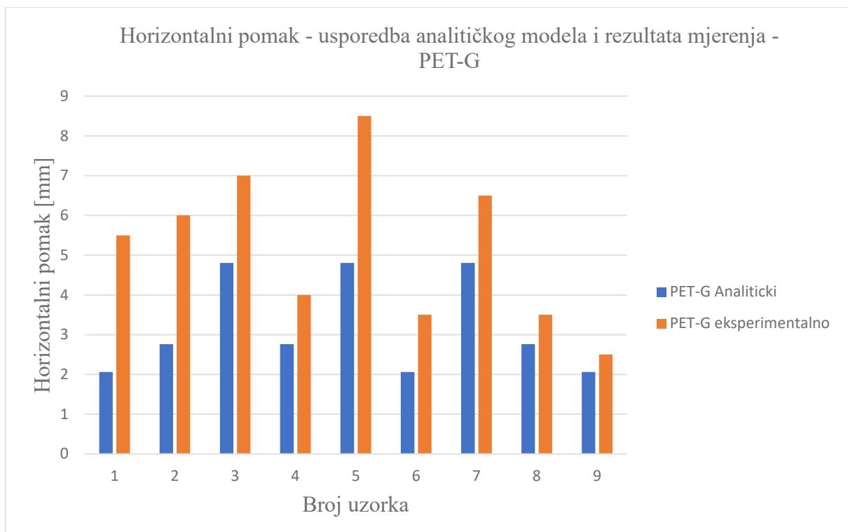
Slika 6.8 Horizontalni pomak - usporedba analitičkog modela i rezultata mjerjenja - PET-G
