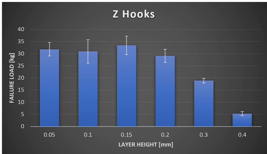
Slika 3.6 Utjecaj visine sloja na vlačnu čvrstoću [20]
