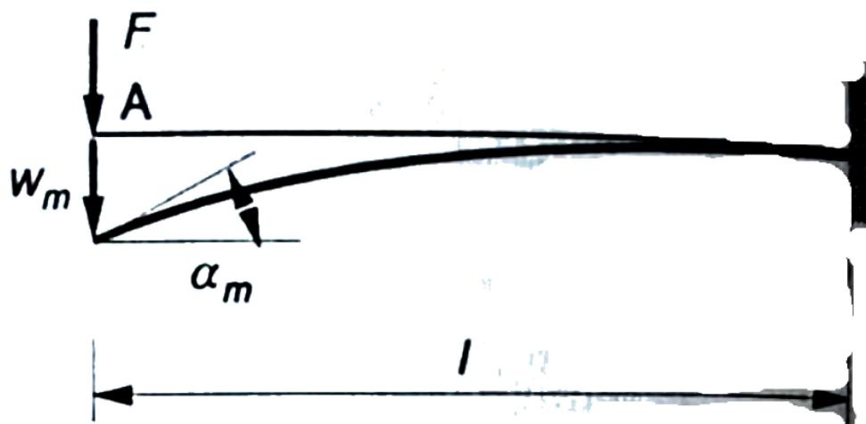
Slika 4.2 Pojednostavljeni Bernoulli- Eulerov model zakrivljenosti [1]
