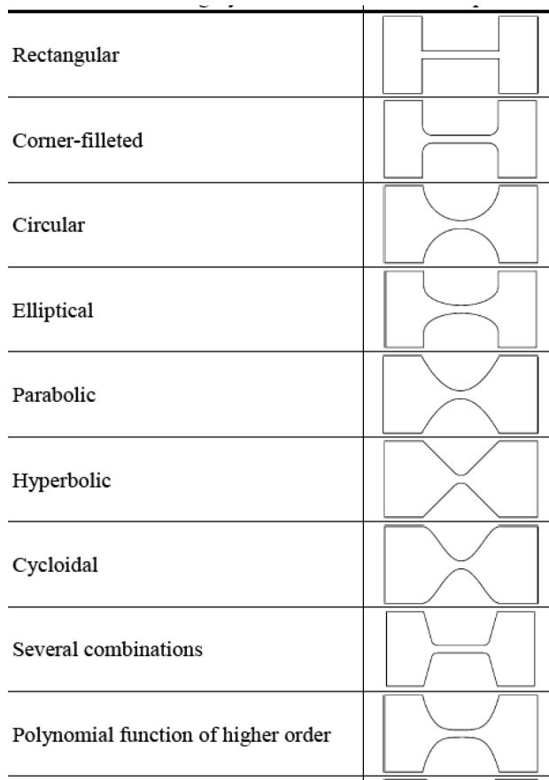
Slika 5.10 Vrste prijelaza između podatljivih elemenata i krutih dijelova konstrukcije [1]
