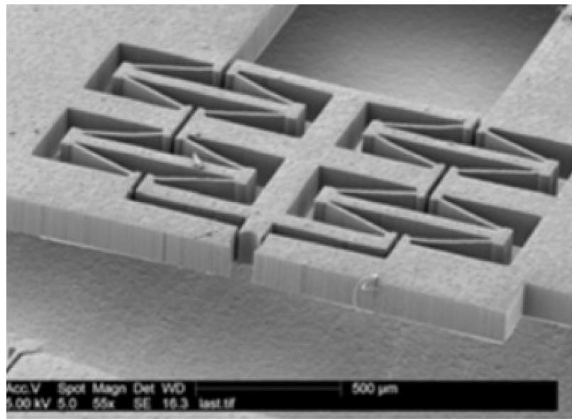
Slika 2.22 Podatljivi mehanizam dobiven LIGA metodom [18]
