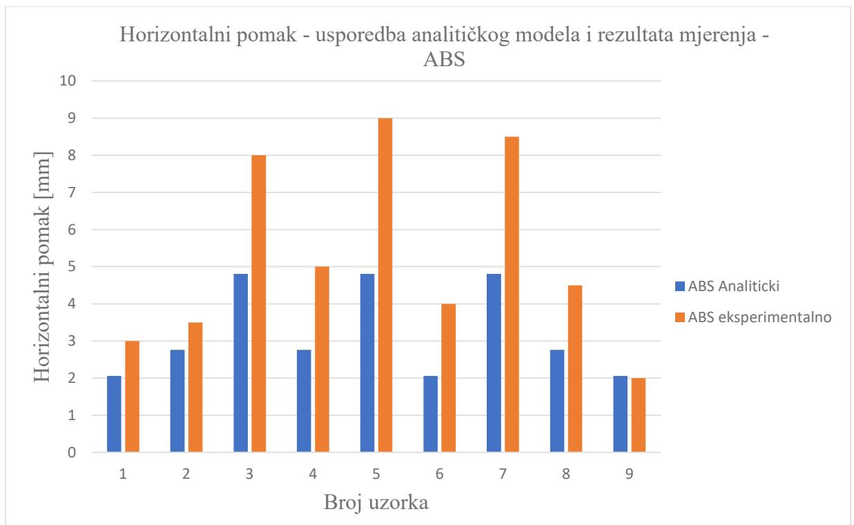
Slika 6.6 Horizontalni pomak - usporedba analitičkog modela i rezultata mjerena – ABS
