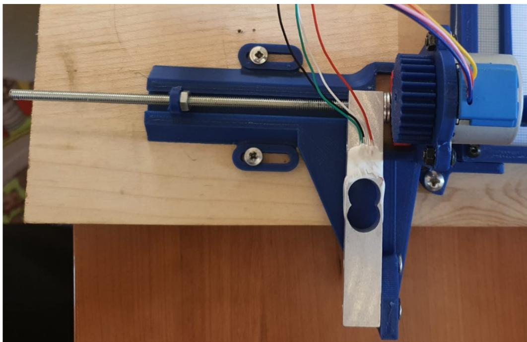
Slika 5.19 Realizirani testni sklop za pokretanje i mjerjenje sile
