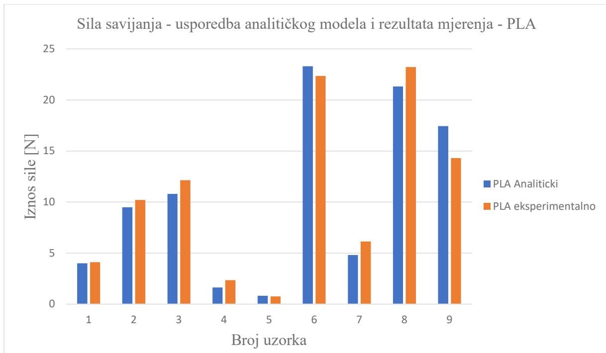
Slika 6.3 Sila savijanja - usporedba analitičkog modela i rezultata mjerena – PLA
