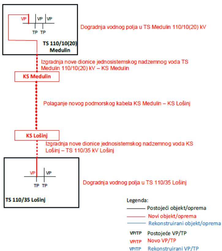
Slika 27. shematski prikaz izgradnje novog DB/KB Medulin-Lošinj
