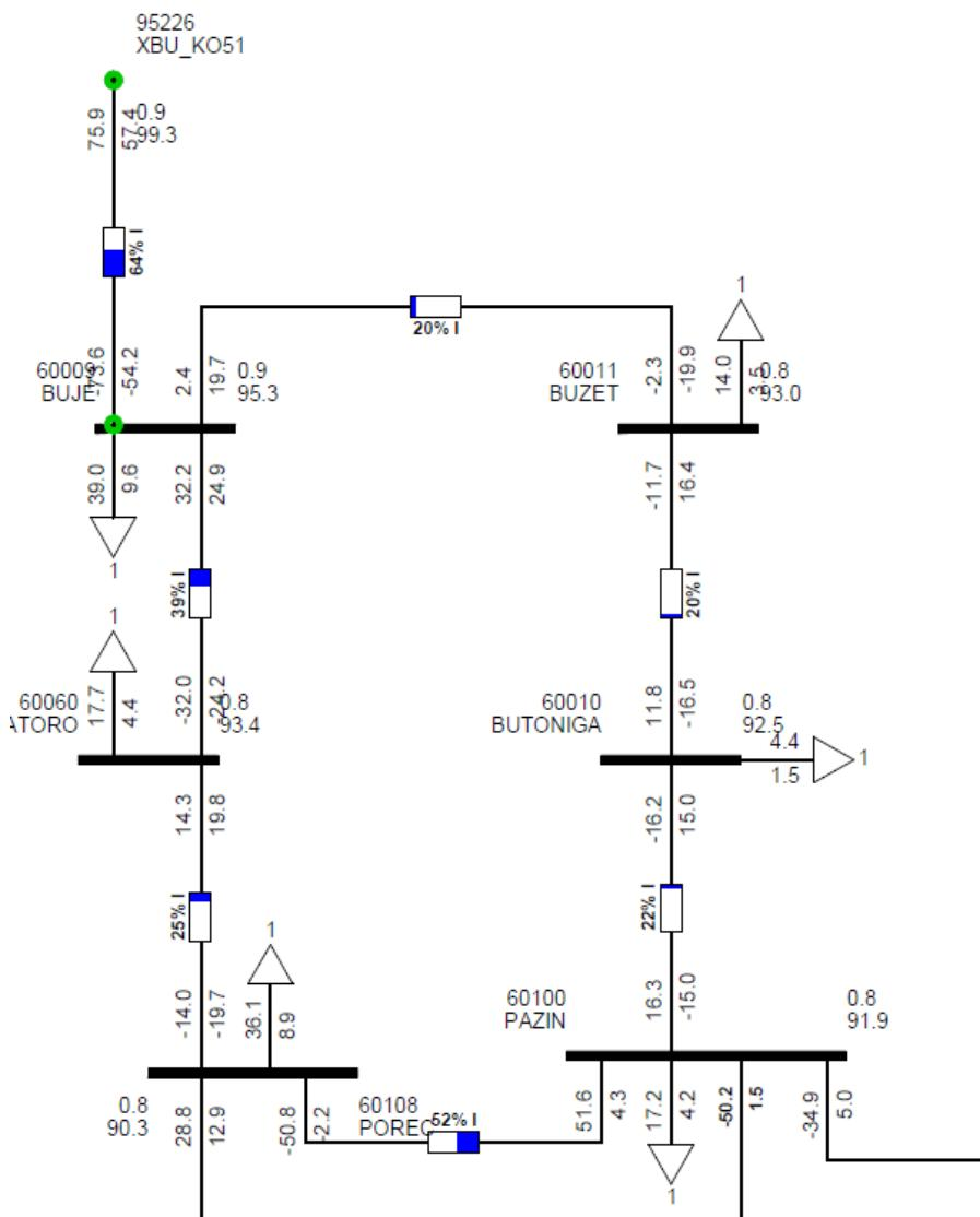
Slika 24. isječak simulacije nakon povećanja prijenosne moći DV 110 kV Buje- Kopar (Neraspoloživost dvosistemskog DV 220 kV)
