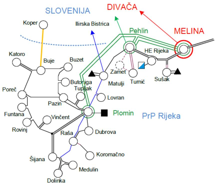
Slika 23. Povećanje prijenosne moći DV 110 kV Buje-Kopar
