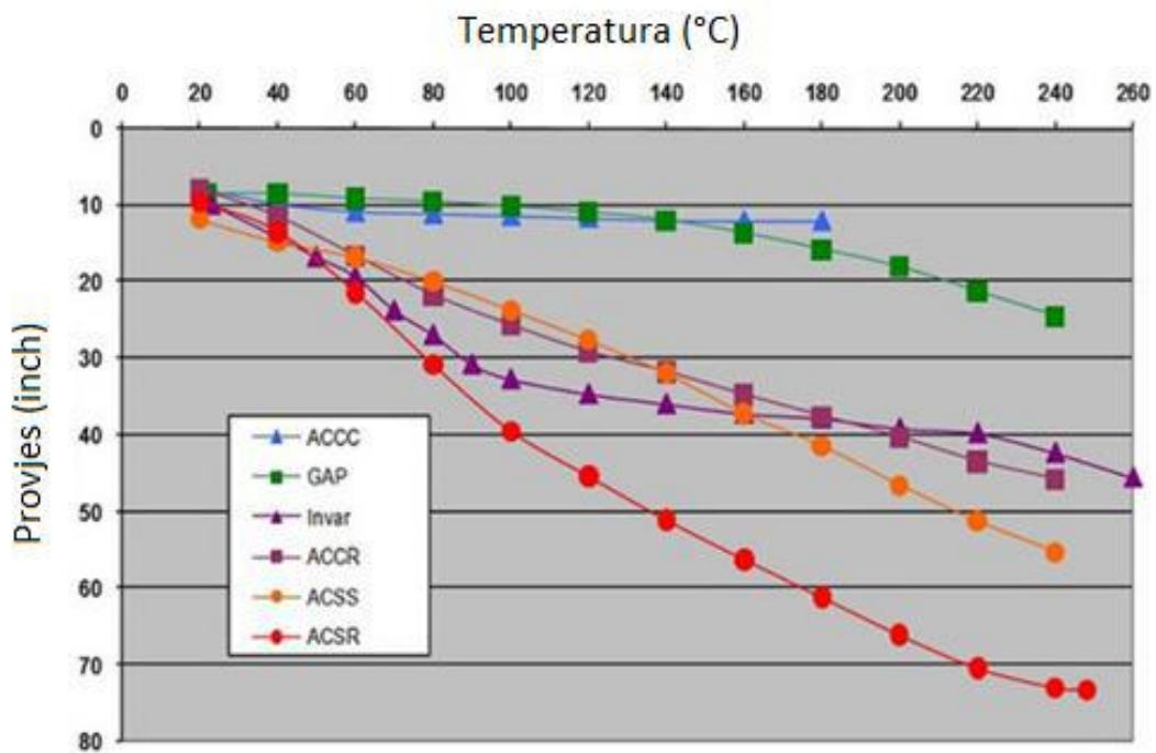
Slika 10. Usporedba provjesa različitih vrsta HTLS vodiča ovisno o temperaturi rada
