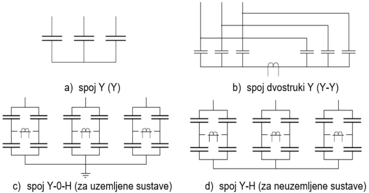
Slika 14. Mogući načini spajanja kondenzatorskih baterija na mrežu
