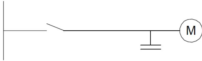
Slika 11. Pojedinačna/direktna kompenzacija
