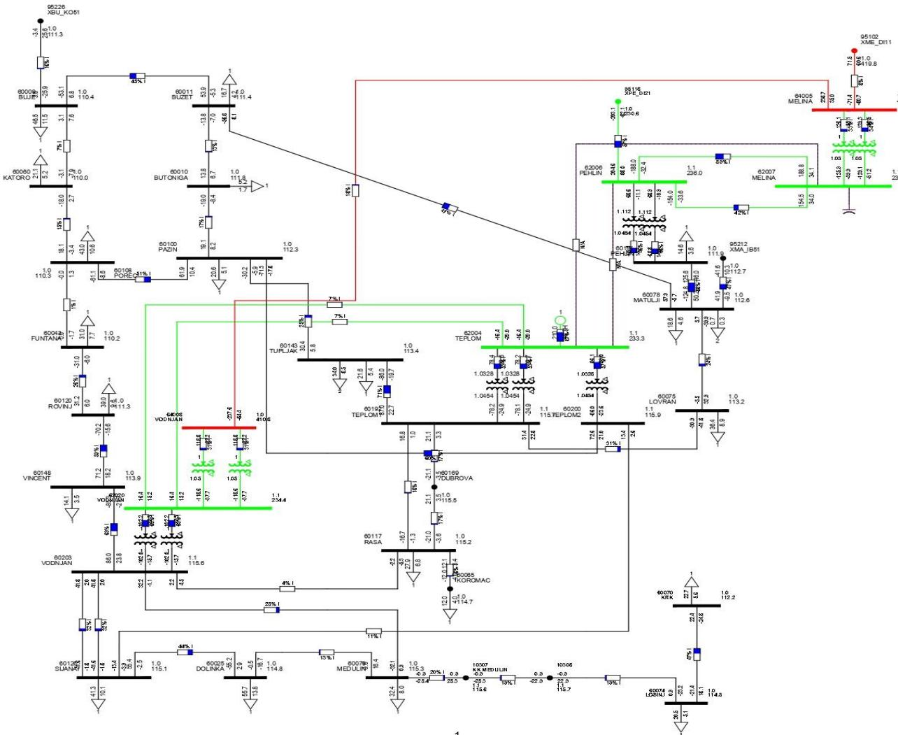
Prilog 24. simulacija Istarskog elektroenergetskog podsustava nakon nadogradnje transformatorske stanice 400/220/110 kV Vodnjan za vrijeme neraspoloživosti TE Plomin 2 i dvosistemskog DV 220 kV Melina-Plomin i Pehlin (N-3).
