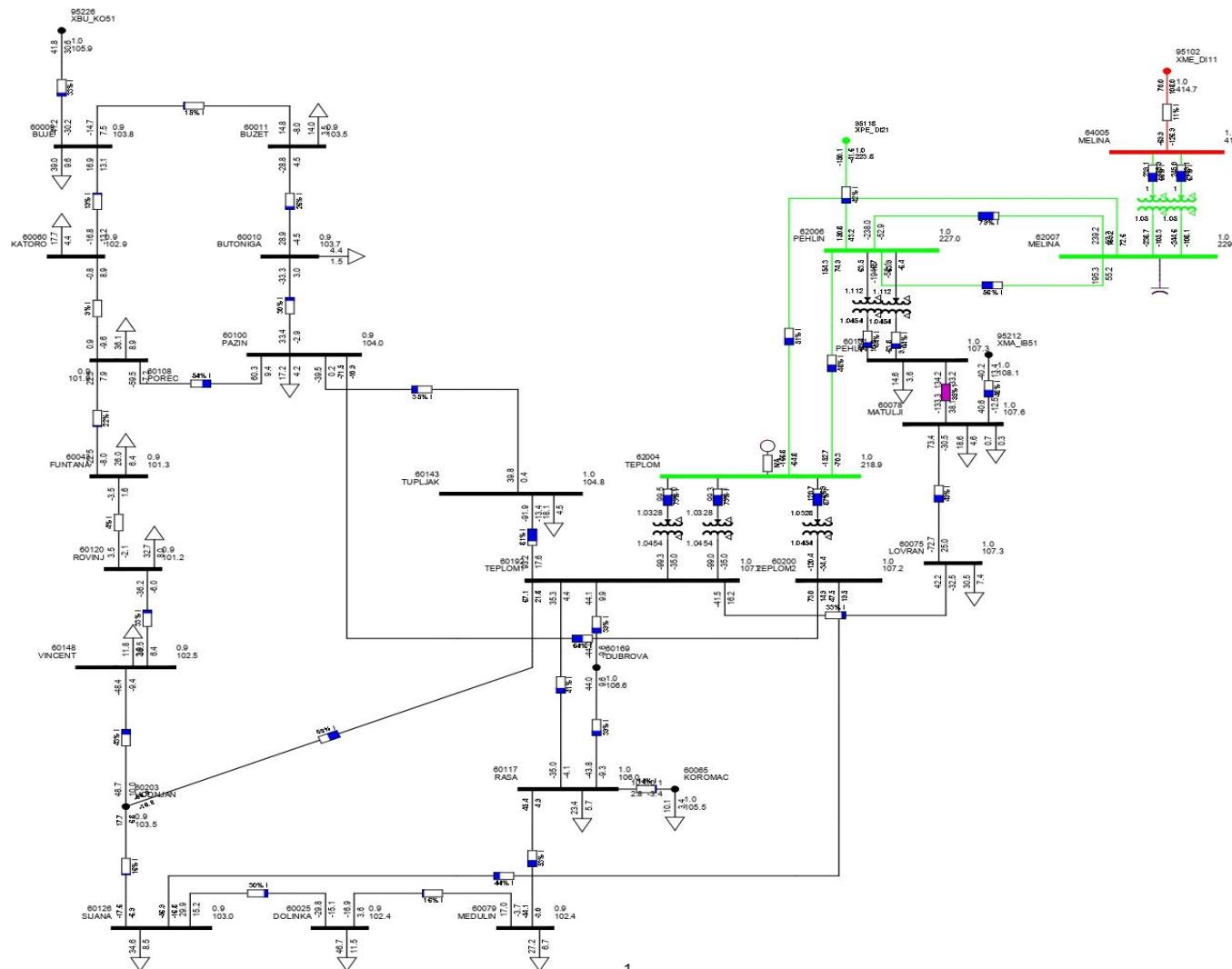
Prilog 8. simulacija Istarskog elektroenergetskog podsustava nakon povećanja prijenosne moći DV 110 kV Buje-Kopar za vrijeme neraspoloživosti dvosistemskog DV 220 kV Melina-Plomin i Pehlin (N-2).
