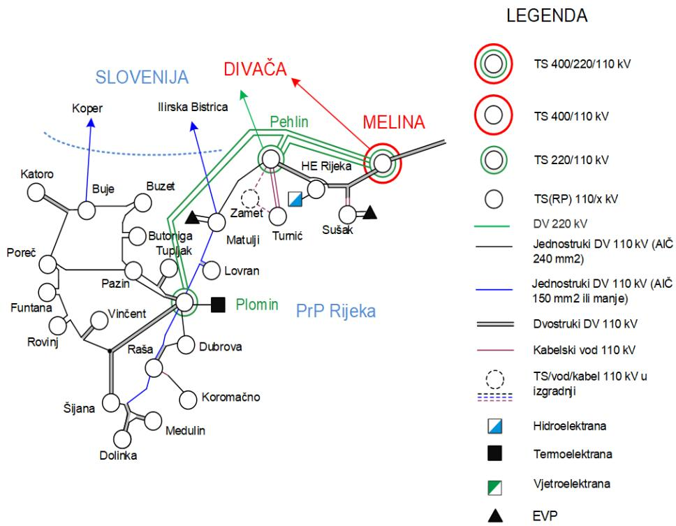
Slika 3. Konfiguracija elektroenergetskog podsustava Istre
