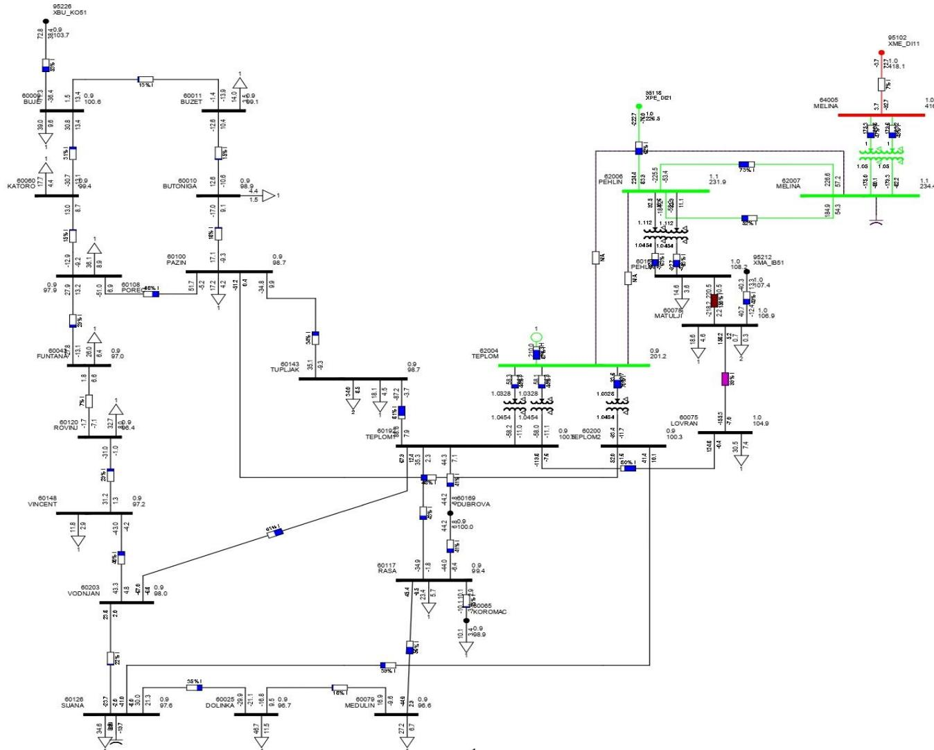
Prilog 12. simulacija Istarskog elektroenergetskog podsustava nakon ugradnje kondenzatorskih baterija u Transformatorske stanice 110 kV Šijana i Poreč za vrijeme neraspoloživosti TE Plomin 2 i dvosistemskog DV 220 kV Melina-Plomin i Pehlin (N-3).
