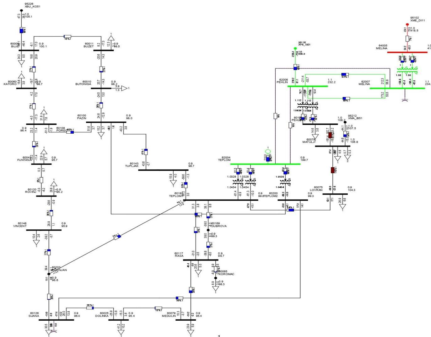
Prilog 3. simulacija trenutnog stanja Istarskog elektroenergetskog podsustava za vrijeme neraspoloživosti TE Plomin 2 i dvosistemskog DV 220 kV Melina-Plomin i Pehlin Plomin (N-3).
