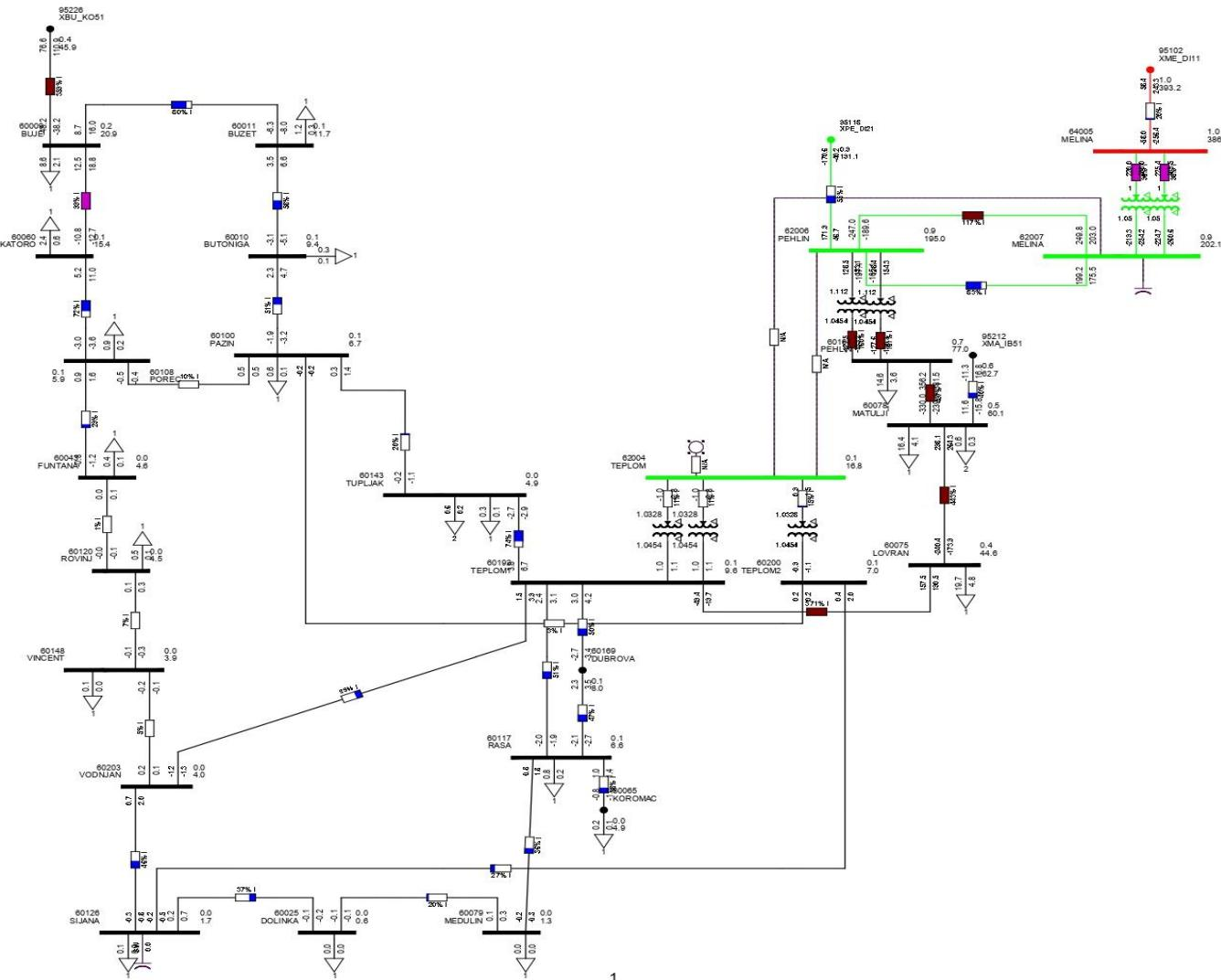
Prilog 7. simulacija Istarskog elektroenergetskog podsustava nakon povećanja prijenosne moći DV 110 kV Buje-Kopar za vrijeme neraspoloživosti TE Plomin 2 (N-1).
