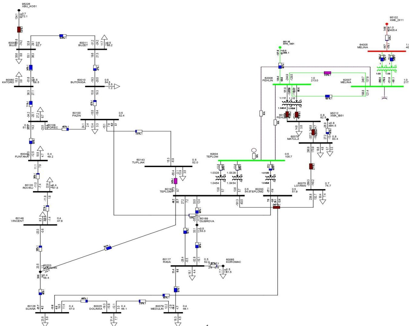
Prilog 10. simulacija Istarskog elektroenergetskog podsustava nakon ugradnje kondenzatorskih baterija u Transformatorske stanice 110 kV Šijana i Poreč za vrijeme neraspoloživosti TE Plomin 2 (N-1).
