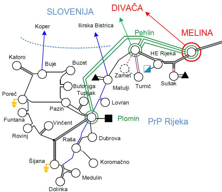
Slika 25. Prikaz lokacija ugradnje kondenzatorskih baterija
