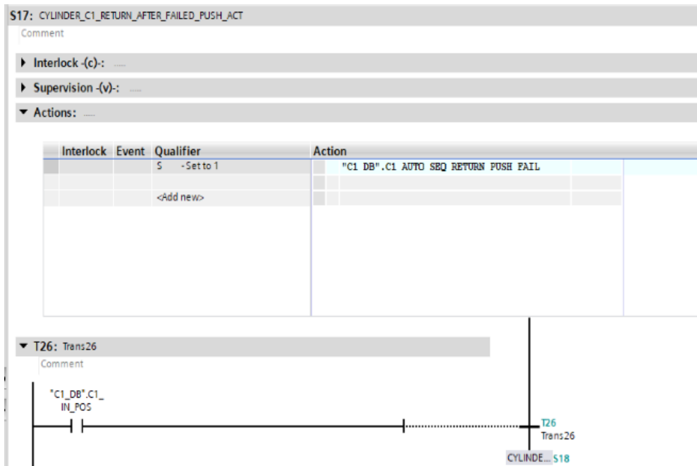
Slika 5.12. Sedamnaesti korak automatske sekvence – povratak cilindra C1 nakon neuspješnog prešanja
