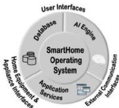
Slika 2.12. Sastav središnje upravljačke jedinice [2]
