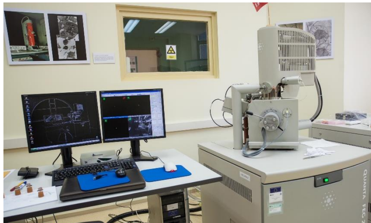
Figure 24. FEG quanta 250 FEI SEM
