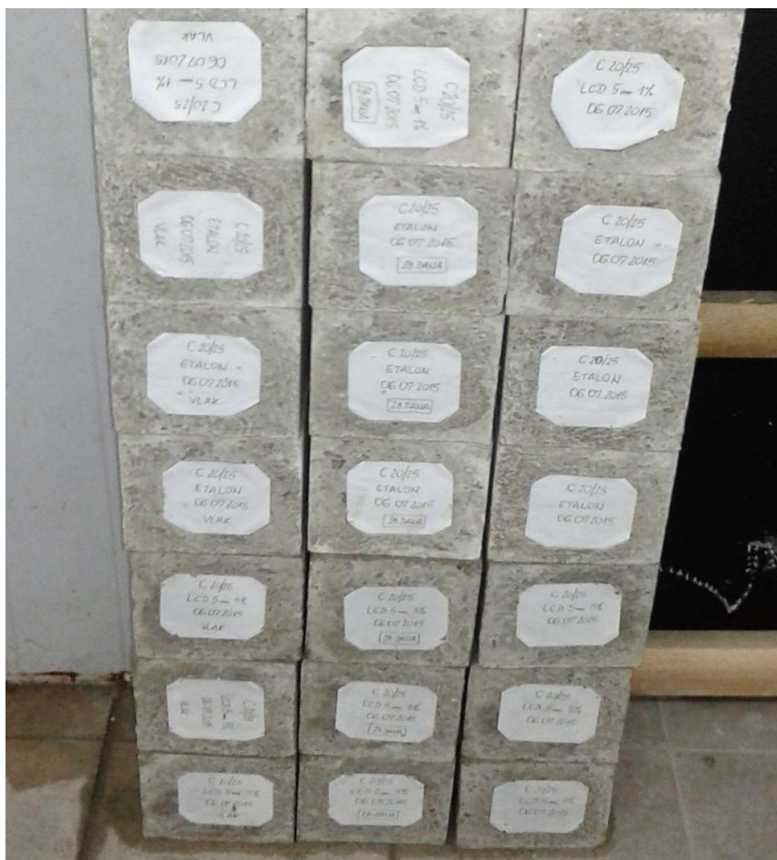
Slika 35 Betonske testne kocke u vlažnoj komori
