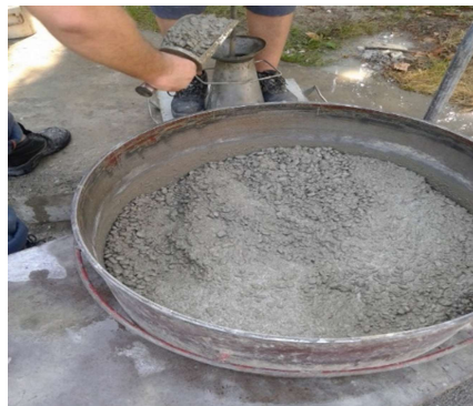
Slika 30 Betonska mješavina s 1% zamjene otpadnog LCD 10
