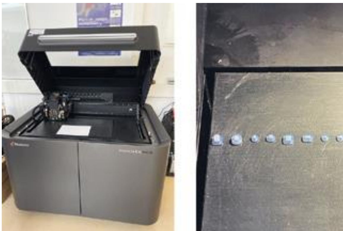
Slika 5.1. 3D printer kojim će se izvršiti priprema uzoraka čestica mikroplastike (1D, 2D i 3D čestice – desna slika, bijeli dio su čestice, plavi dio je baza koje se ispire) [4]
