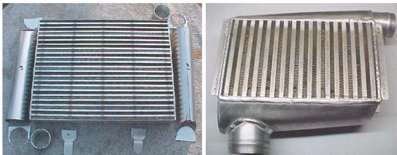
Slika 5.1.1. Izvedbe hladnjaka zraka za prednabijanje [8]
