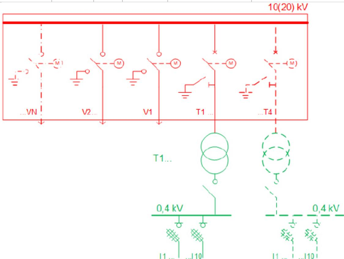
Slika 3.1. Prikaz pojednostavljene shema TS 10(20)/0,4 kV – kabelska izvedba [15]
