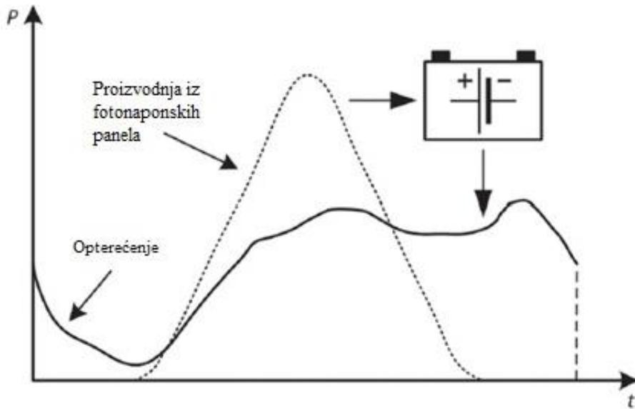
Slika 4.10. Solarni sustav s baterijskim spremnikom energije
