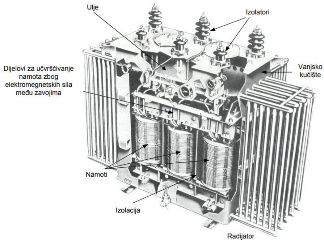
Slika 2.2. Prikaz dijelova transformatora [5]
