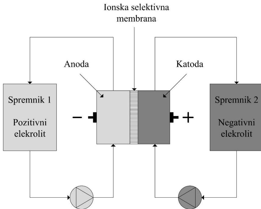
Slika 4.6. Princip rada vanadijeve reduksijske baterije s protokom
