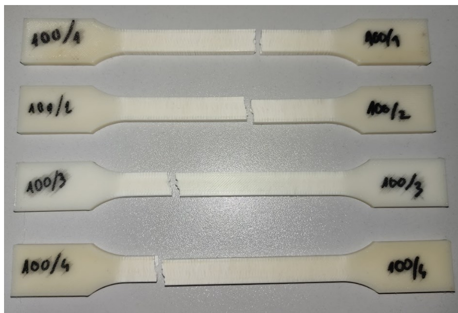
Slika 6.10 Pokidane epruvete sa 100% ispune
