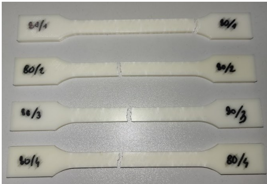
Slika 6.12 Pokidane epruvete s 80% ispune
