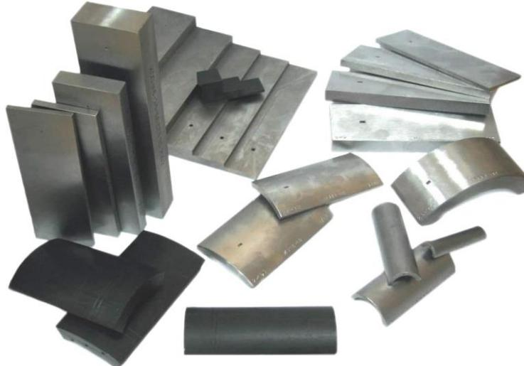
Slika 4.2.3 Etaloni za ultrazvučno ispitivanje
