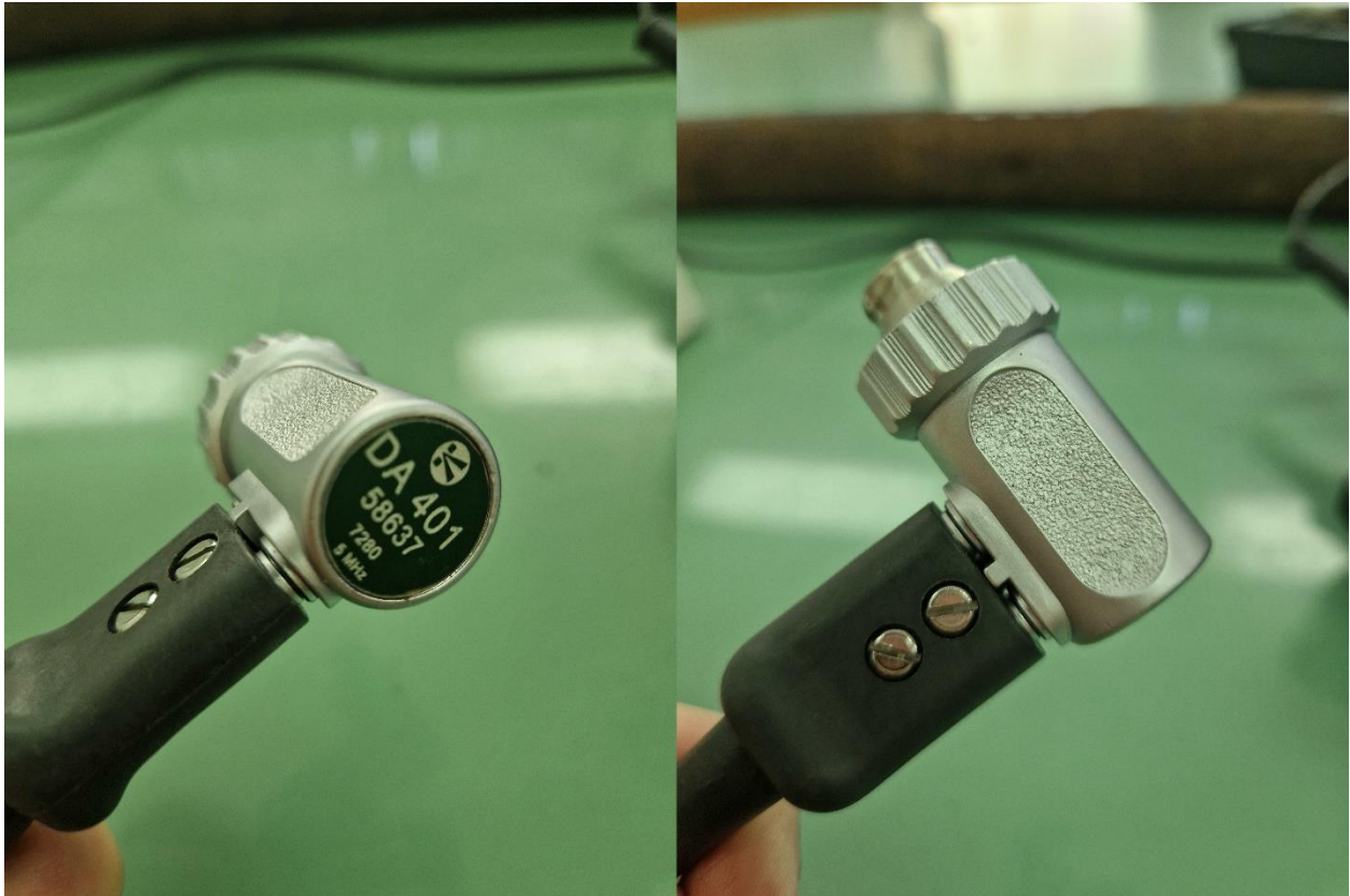
Slika 4.6.2 Ultrazvučna sonda General Electric DA 401
