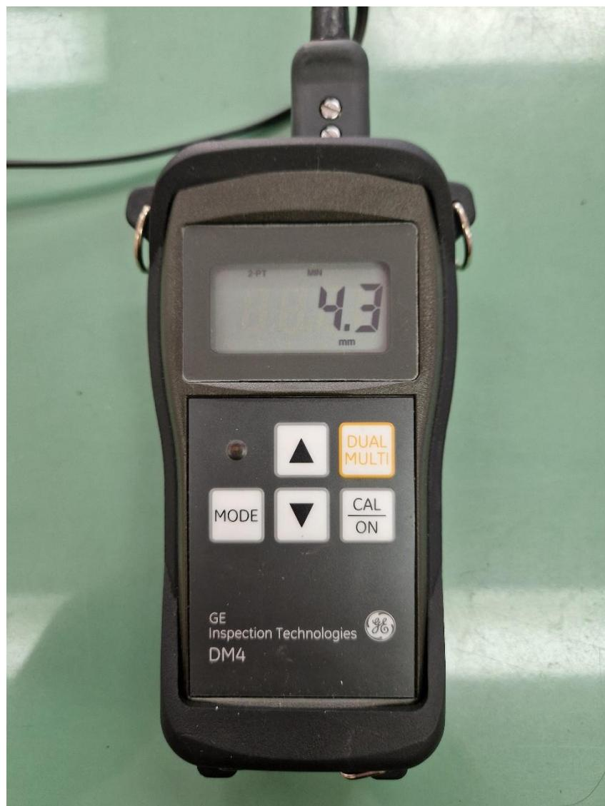
Slika 4.7.1 Rezultat mjerjenja debljine cijevi ultrazvukom
