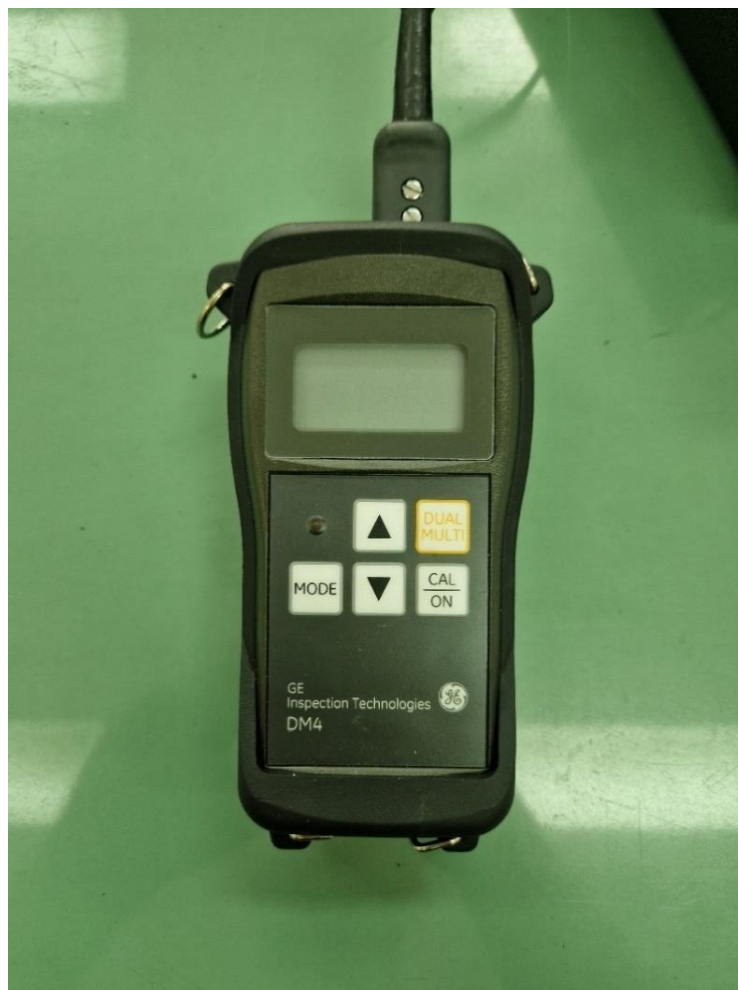
Slika 4.6.1 Ultrazvučni uređaj General Electric DM4
