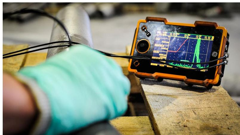
*Slika 2.3.3 Ultrazvučno ispitivanje*
