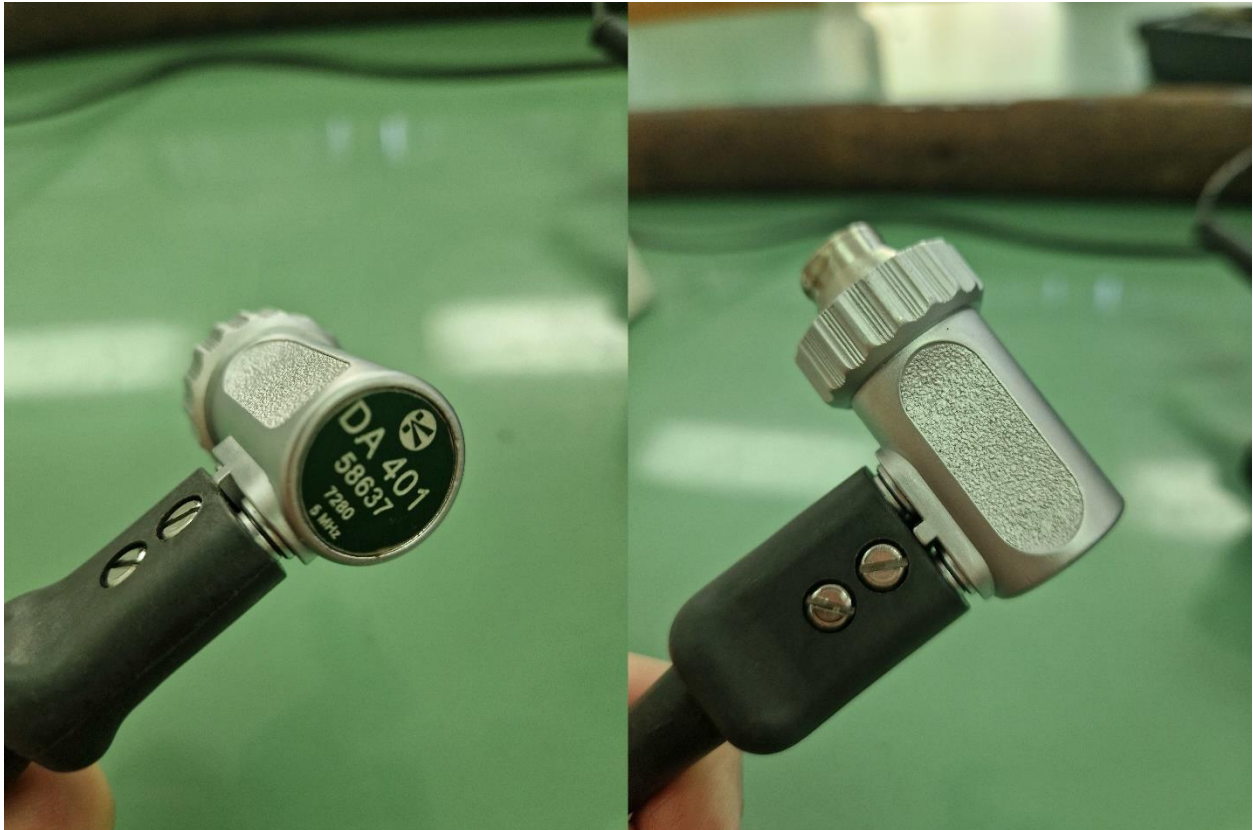
Slika 4.6.2 Ultrazvučna sonda General Electric DA 401
