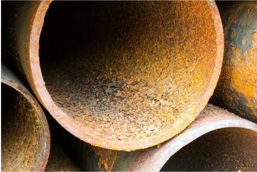
Slika 4.4.1 Primjer unutarnje korozije cijevi
