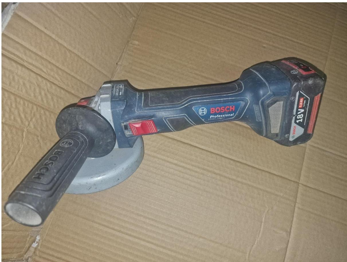
*Slika 4.1 Ručna akumulatorska brusilica s BLDC motorom*
