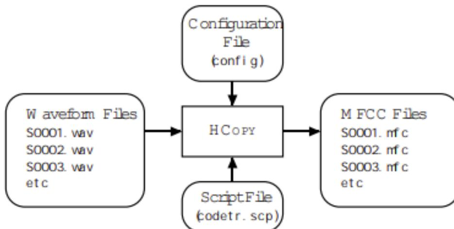
Slika 4.3.5. Ilustracija postupka kodiranja (.wav u MFCC) [10]
