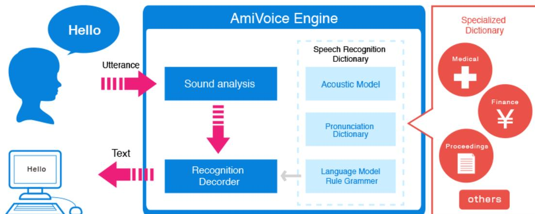
Slika 4.1. Princip rada osnovnog Speech Recognition Engine-a (SRE) [4]
