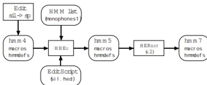
Slika 5.2.3. Ilustracija postupka ispravljanja modela tišine [10]
