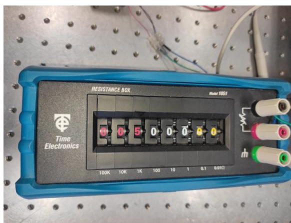
Slika 4.4 Otporna dekada TE 1051 pri iznosu od 5\text{ k}\Omega
