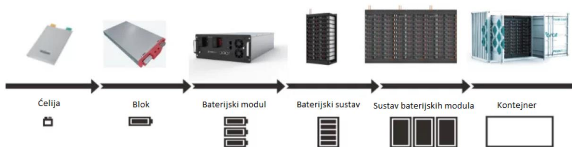
Slika 5. 16 Sastav baterijskog sustava unutar kontejnera [11]
