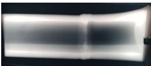
Slika 3.20. Sloj pijeska u usisnoj cijevi vodospreme
