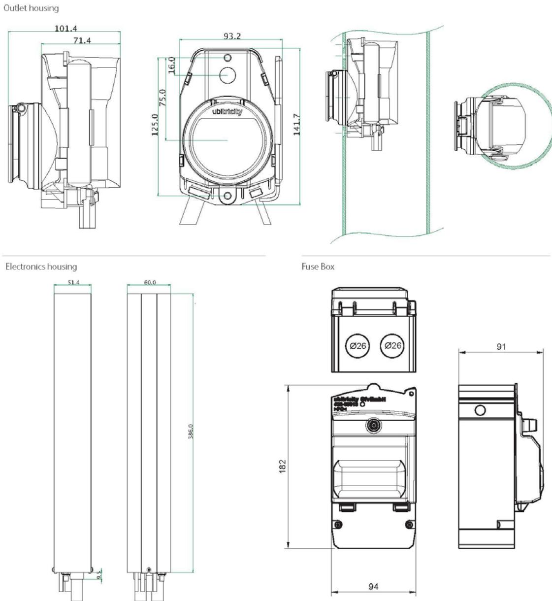
Slika 5.11 Dimenzije stupa s integriranim električnom punionicom(1)
