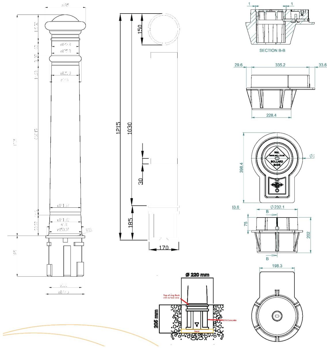
Slika 5.12 Dimenzije stupa s integriranim električnom punionicom(2)
