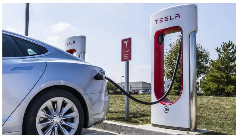
Slika 2.7 Superbrzi punjač za električna vozila[19]
