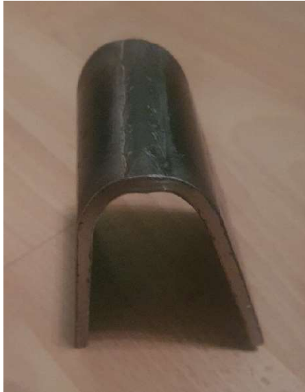
Slika 27 Uzorak 1 savijanje preko čela zavara
