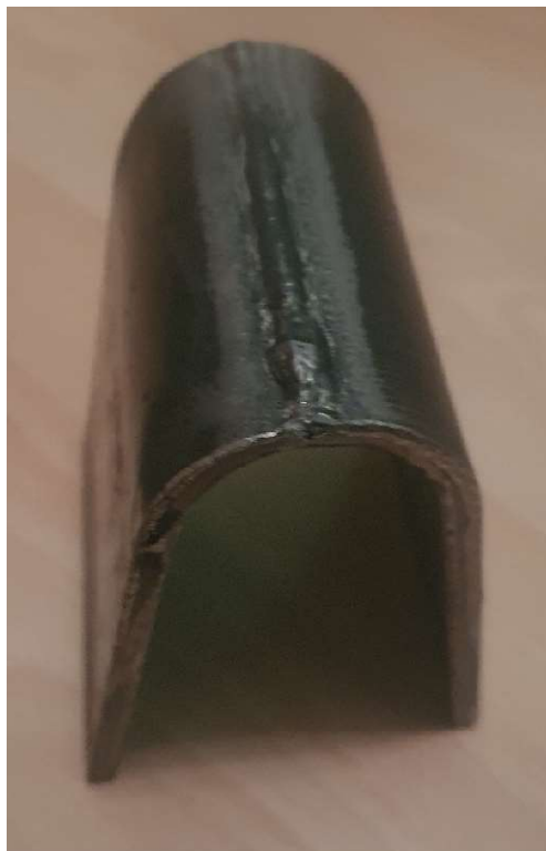
Slika 29 Uzorak 3 savijanje preko korijena zavara
