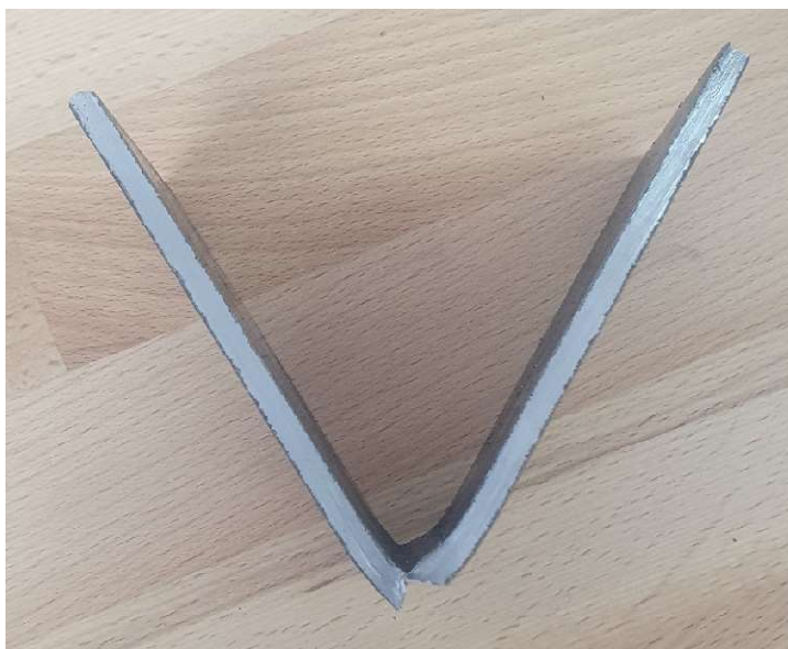
Slika 29 Uzorak 3 savijanje preko korijena zavara
