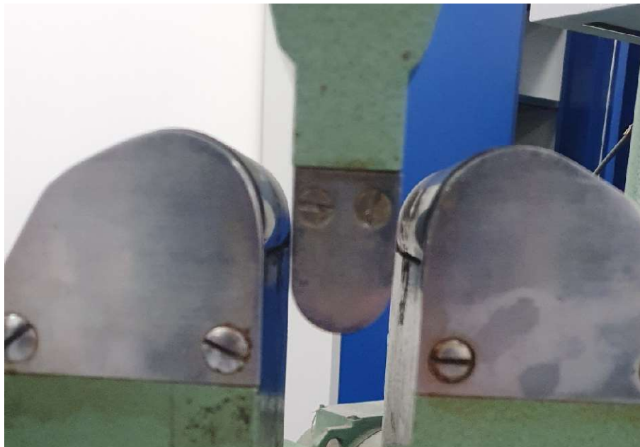
Slika 26 Namještena kidalica prema normi DIN EN 910
