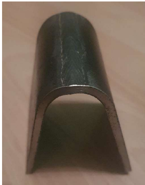
Slika 27 Uzorak 1 savijanje preko čela zavara
