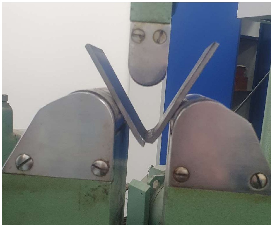
Slika 31 Pucanje uzorka 4 u kidalici
