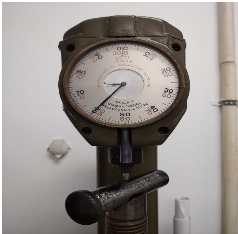
Slika 4.11. Ispitivanje tvrdoće poslije niskotemperaturnog popuštanja (61 HRC)
