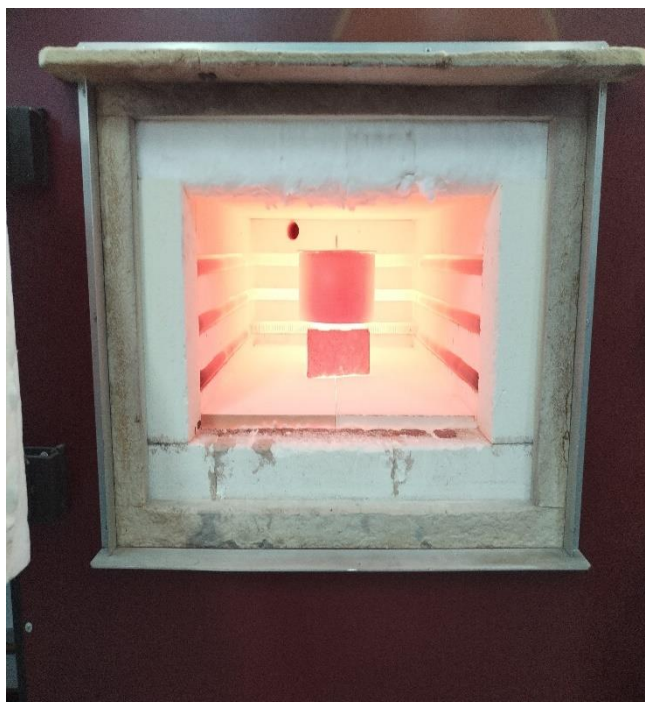
Slika 4.8. Hlađenje nakon pougljičavanja
