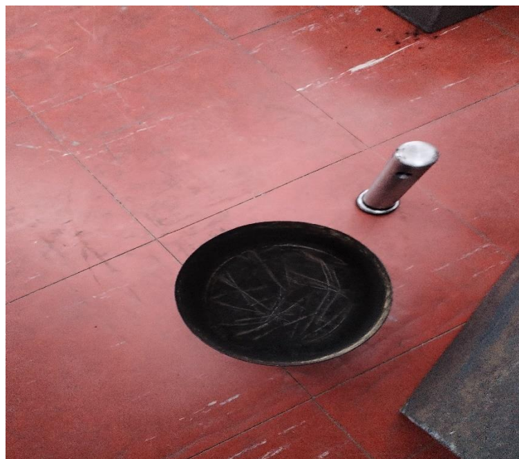
Slika 4.5. Posuda za pougljičavanje i strojni dio
