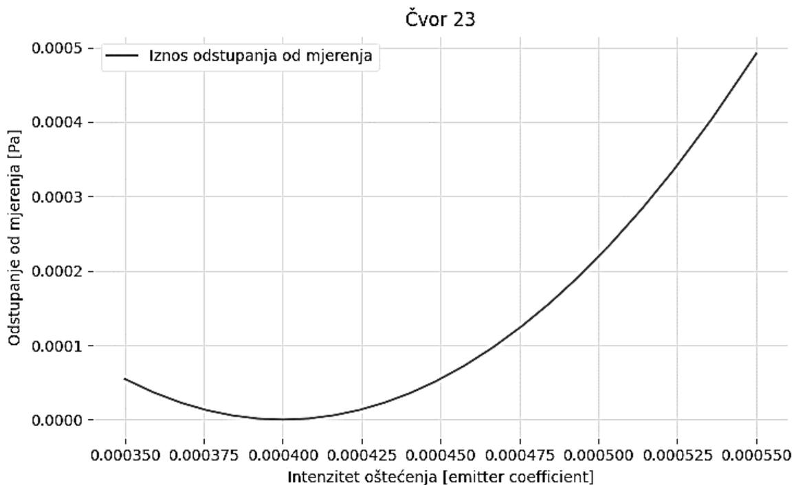
Slika 5.11 Funkcija intenziteta oštećenja za čvor 23
