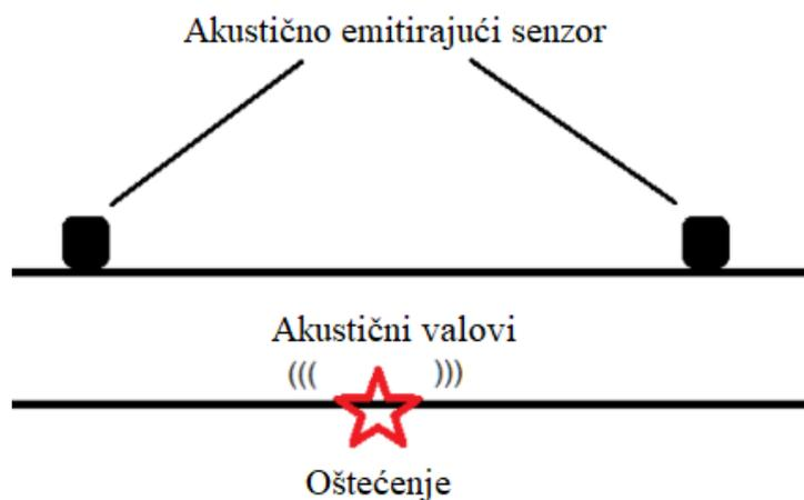
*Slika 3.2 Senzori za detekciju oštećenja putem akustičnog slušanja [5]*
