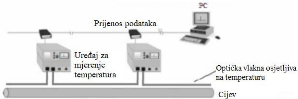
Slika 3.6 Metoda primjene senzora s optičkim vlaknima [5]
