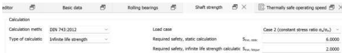
Slika 4.31 Odabir parametara čvrstoće vratila 2
