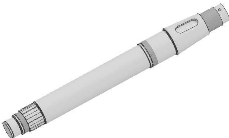
Slika 5.7 3D model gonjenog vratila 1
