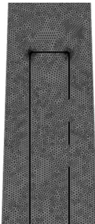
Slika 5.2 Detalj omrežene geometrije irigacijske igle s dva otvora
