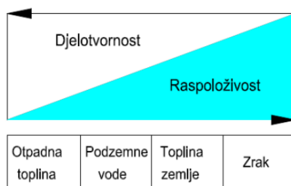
Slika 4.5. Izvori topline za dizalice topline[10]
