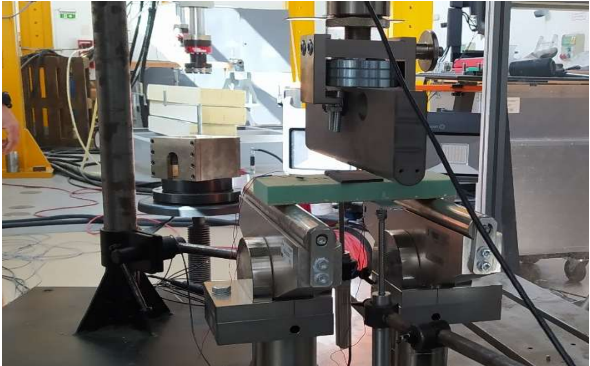
Slika 3.5 Uzorak pripremljen za testiranje na kidalici, te pozicioniran i spojen na mjerne uređaje.
