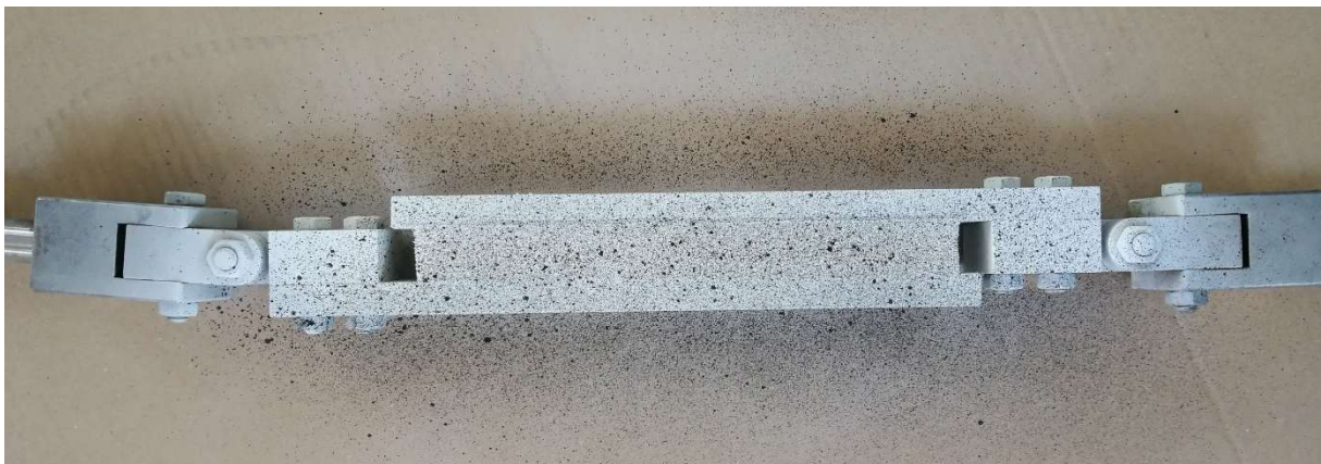
Slika 3.9 Uzorak namijenjen vlačnom smjeru nanošenja pomaka obojan posebnim točkastim uzorkom za praćenje pomaka uz upotrebu DIC tehnologije (GOM Aramis).
