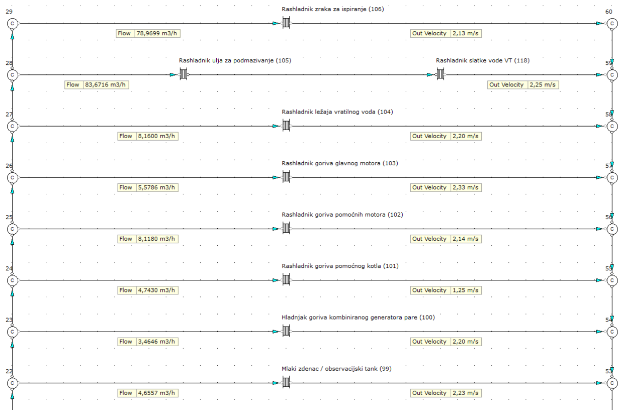
Slika 5.6. Model kruga slatke vode niske temperature, detalj
