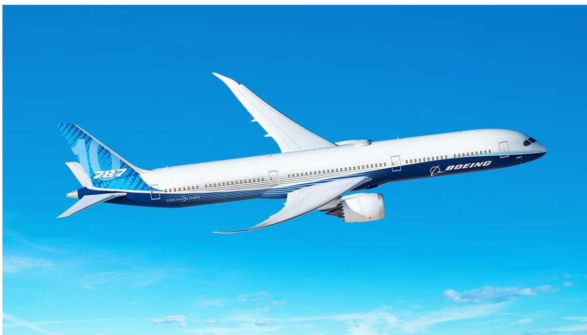
Slika 12 Boeing 787 s GENx motorima
