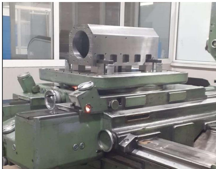
Slika 2.7. Kućište motorvretena nakon izrade
