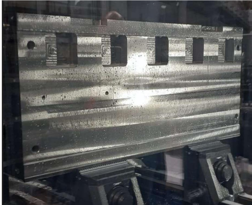
Slika 2.4. Utori kućišta nakon obrade
