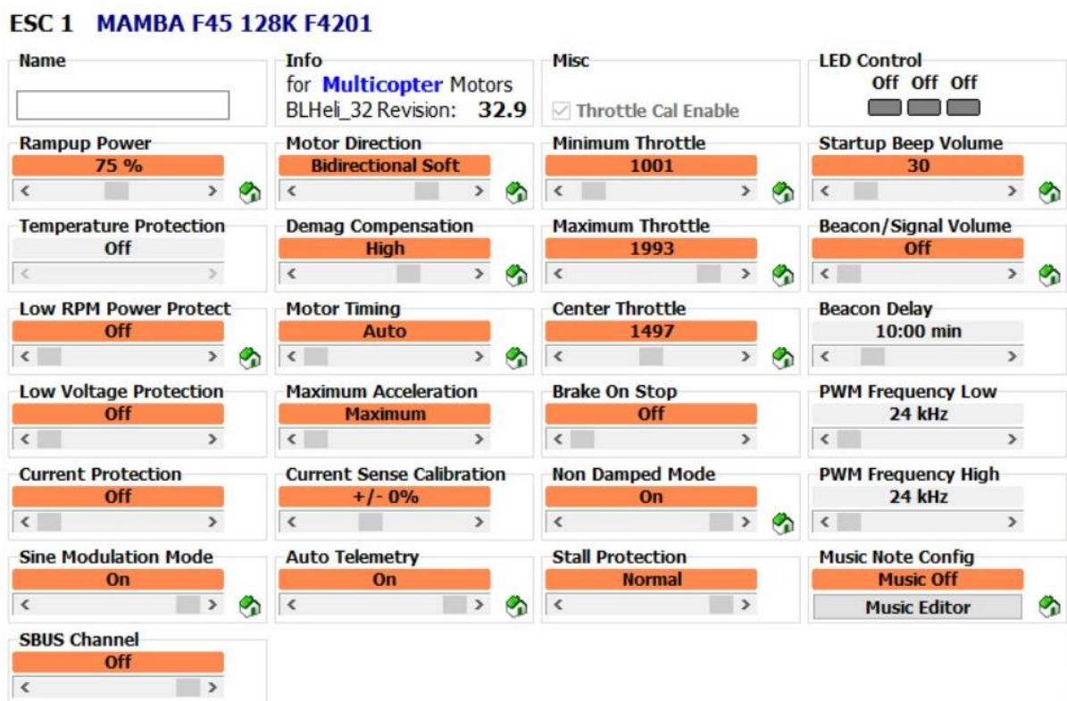
Slika 4.3 Odabrane postavke u BLHeli32 programeru
