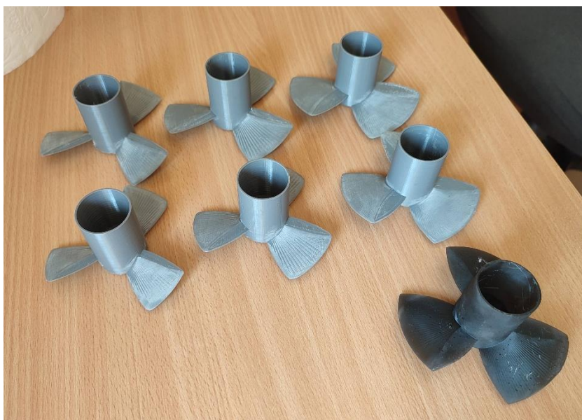
Slika 5.8 Brodski vijci za testiranje
