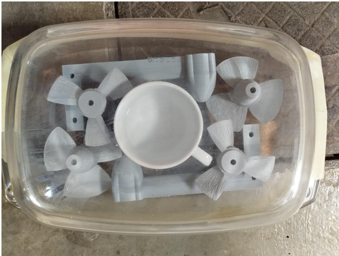
Slika 6.10 Proces zaglađivanja površine brodskih vijaka
