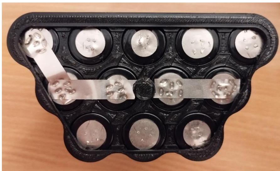
Slika 6.3 Metoda paralelnog spajanja ćelija
