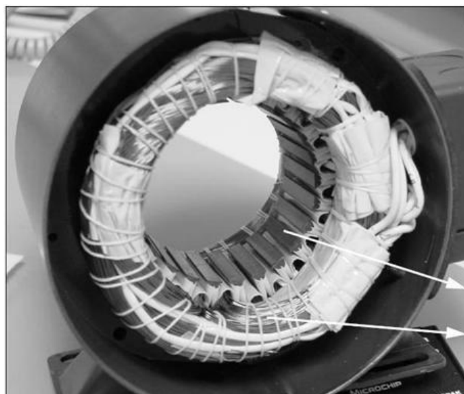
Slika 3.14 stator sinkronog motora
