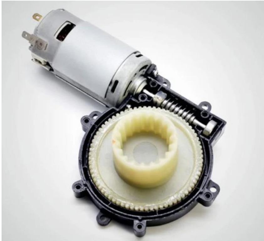
Slika 6.4 El. motor podizača prozora
