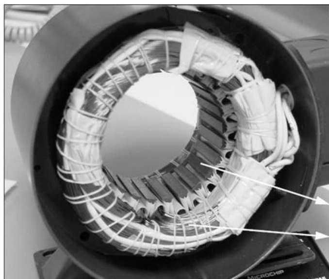
Slika 3.14 stator sinkronog motora
